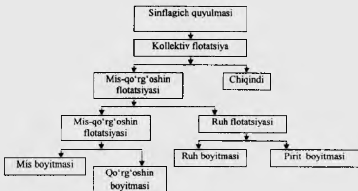
49-rasm. Polimetalli rudalarni kollektiv va selektiv flotatsiyalashning printsipl sxemasi
