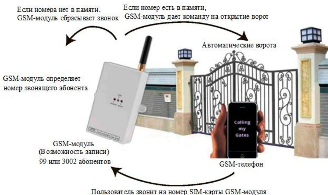
Рис. 6.1. Принцип работы устройства открывание ворот
