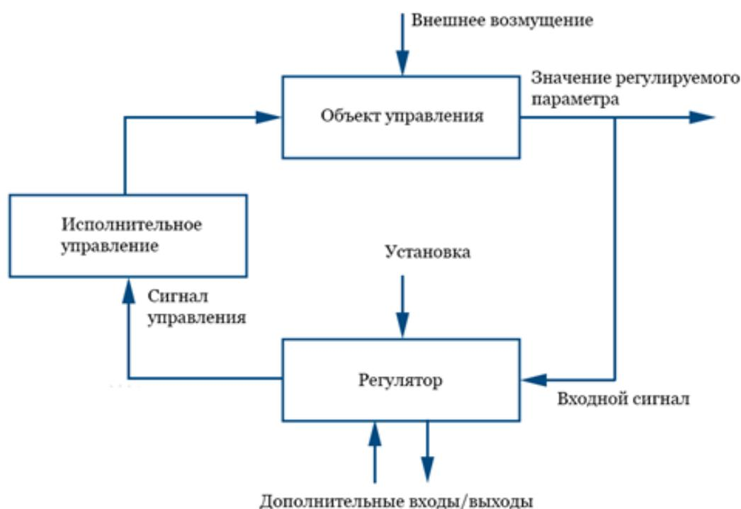
Рис. 6.2. Принципиальная схема GSM-управления
