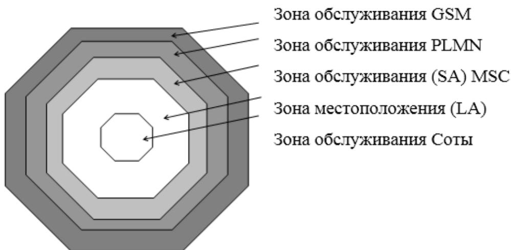
Рис. 1.10. Иерархическая взаимосвязь между зонами GSM
