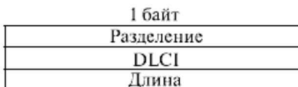
Рис. 3.5. Формат заголовка BSSAP
