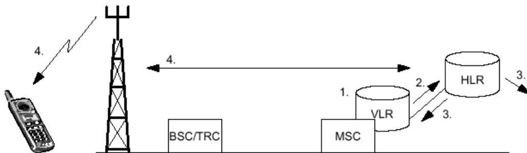
Рис. 2.17. Обновление местоположения, при входе в зону действия обслуживания MSC/VLR
