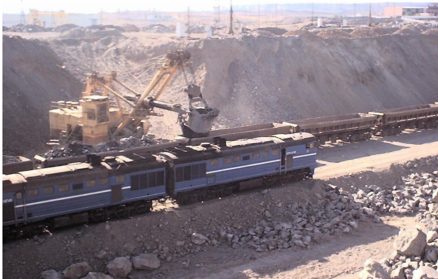
13.1. Rasm. Karyerda temir yo'l transportining ish jarayoni.
