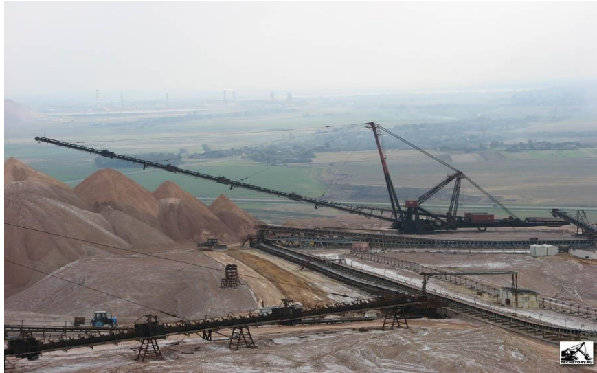
14.5. Rasm. Karyerda ag'darma konveyrni qo'llash.
