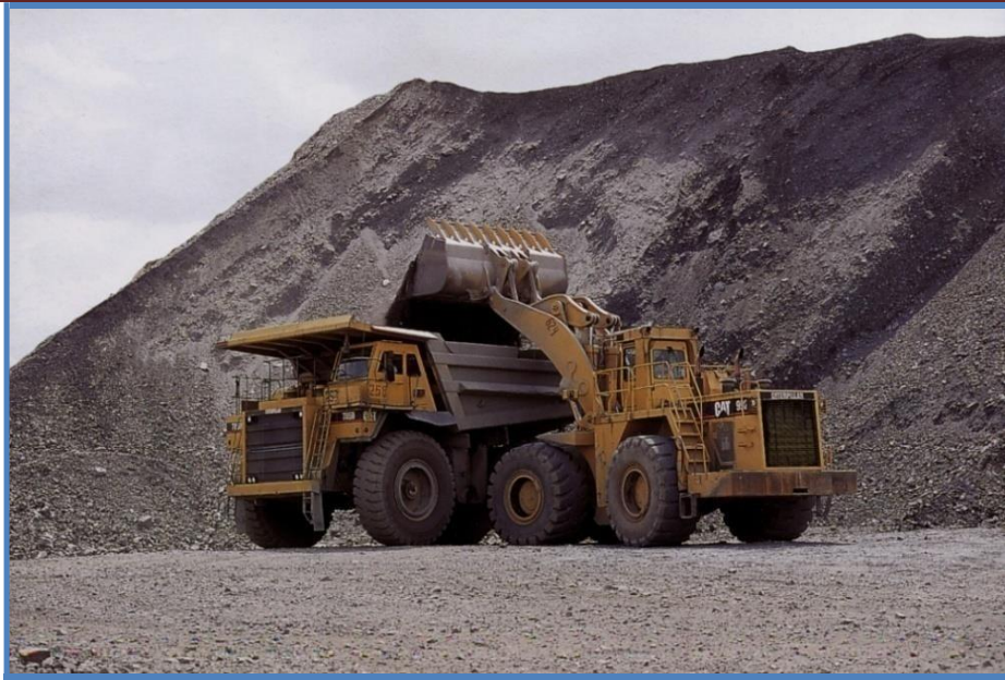
5.3 – rasm. Karyerda yuklagichlar yordamida qazish-yuklash jarayoni.
