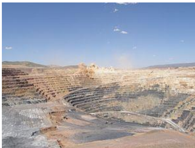
Creeks oltin qazib olish kar'yerda portlatish ishlari. AQSh. Nevada shtati. 2
