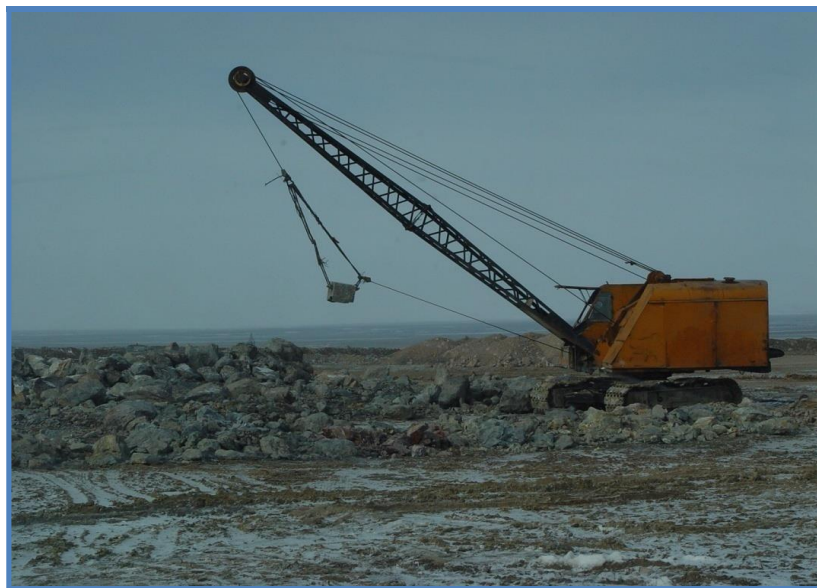
5.2 – rasm. Karyerda draglayn yordamida qazish-yuklash jarayoni.
