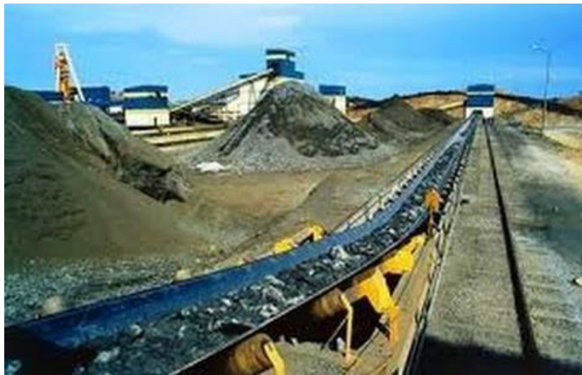
14.4. Rasm. Karyerda magistral konveyrni qo'llash.
