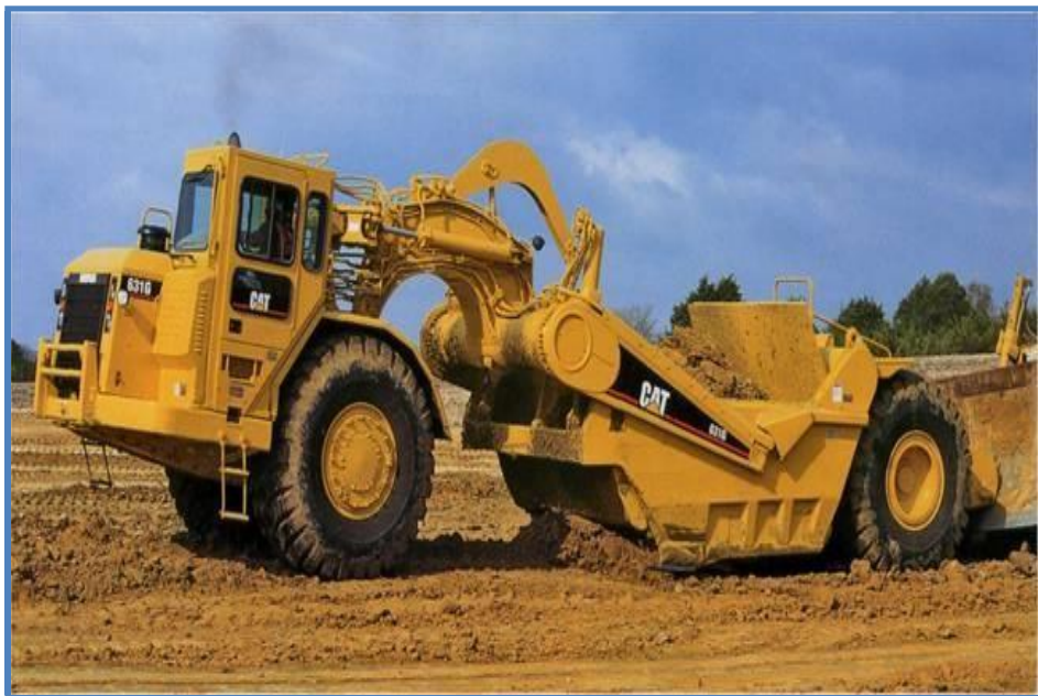
5.4 – rasm. Karyerda skreper ish jarayoni.
