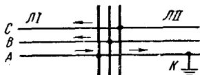
Рис. 7-13. Направление токов в поврежденных и неповрежденных фазах. При к. з. возможно неправильное действие направленной защиты линии II под влиянием токов нагрузки.
