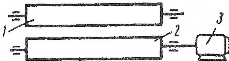
16.4-rasm. Tortish xususiyatini aniqlovchi kuch stendining shakli: 1-ushlab turuvchi baraban; 2-yuklovchi baraban; 3-yuklama beruvchi moslama (tormoz).
