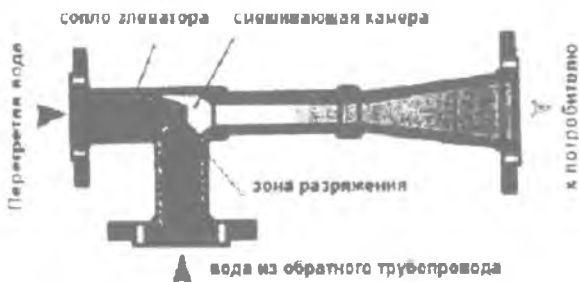
Рис.2.1. Схема водоструйного элеватора.
