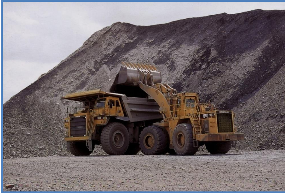
5.3 – rasm. Karyerda yuklagichlar yordamida qazish-yuklash jarayoni.
