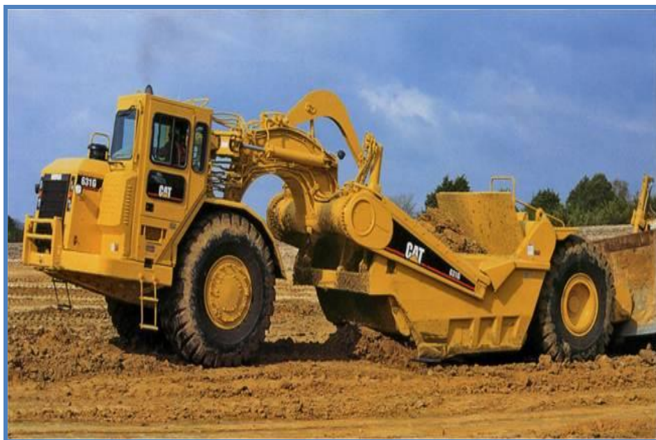
5.4 – rasm. Karyerda skreper ish jarayoni.
