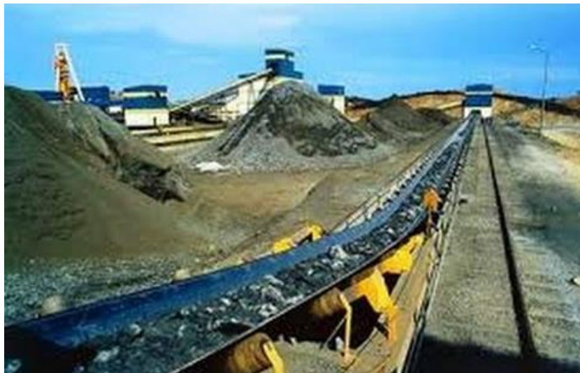
14.4. Rasm. Karyerda magistral konveyrni qo'llash.
