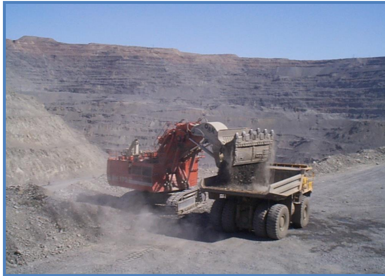
5.1 – rasm. Karyerda bir cho'michli ekskavatorlar yordamida qazish-yuklash jarayoni.
