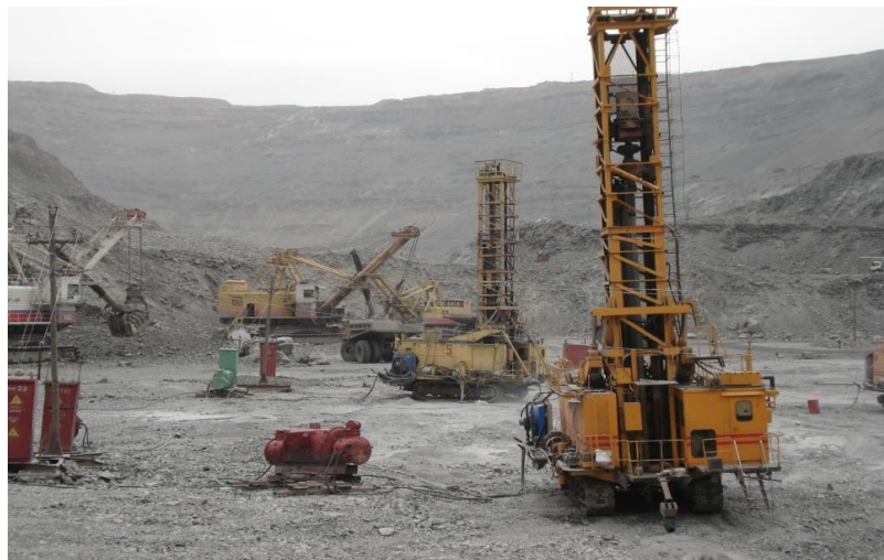
7.1. Rasm. Karyerlarda sharoshkali burg'ulovchi dastgoh yordamida skvajinalarni burg'ulash.
