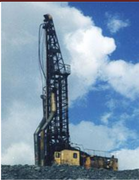
7.3. Rasm. Karyerlarda termik burg'ulovchi SBT-400 MNR dastgohi yordamida skvajinalarni burg'ulash.
