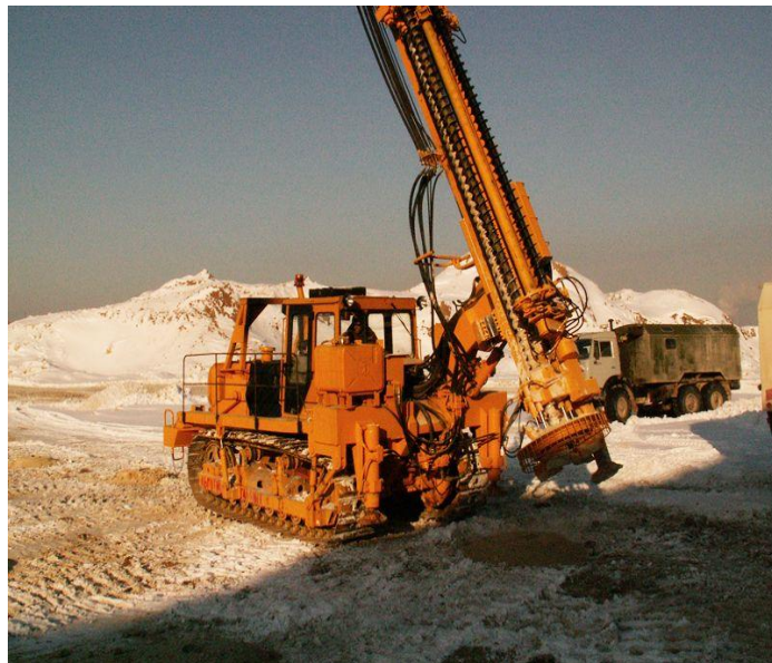
7.2. Rasm. Karyerlarda zarbli – aylanma burg'ulovchi dastgoh yordamida skvajinalarni burg'ulash.
