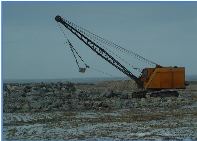
5.2 – rasm. Karyerda draglayn yordamida qazish-yuklash jarayoni.
