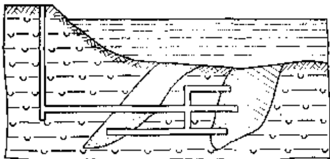
6.9.-Rasm. Suv osti konlarini shaxta bilan qazib olish sxemasi.
