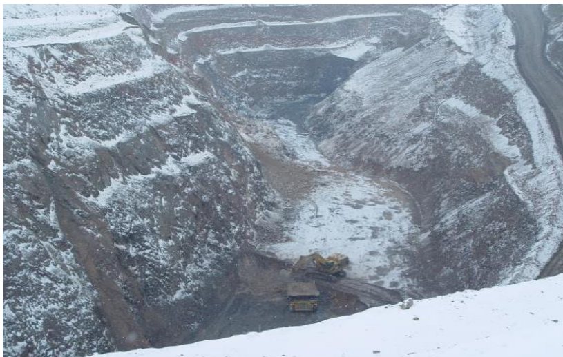
4.4.-Rasm. Kon ishlari fronti bo‘ylamasiga (kar‘yerning uzun o‘qiga nisbatan) borayotgan kar‘yerning ko‘rinishi
