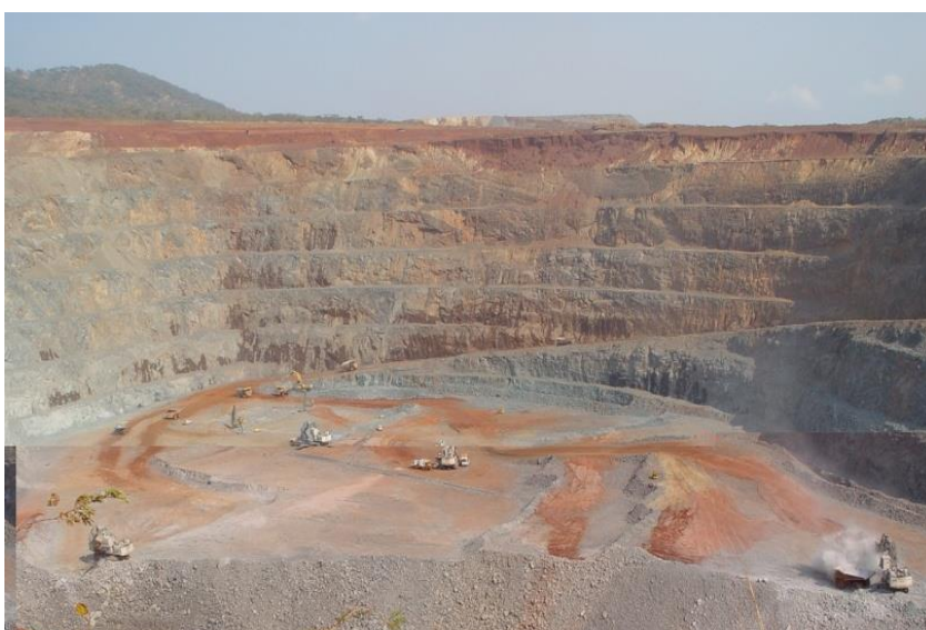
4.6.-Rasm. Kon ishlari fronti aralash borayotgan kar‘yerning ko‘rinishi
