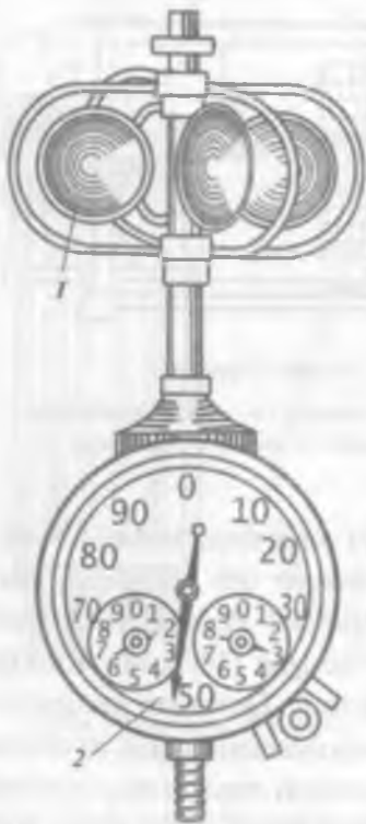
11-rasm. Kosachali anemometr: 1—g'ildirak; 2—korpus.
