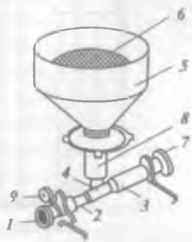
71-rasm. ПГ-100 ko'pik generatorining sxemasi
