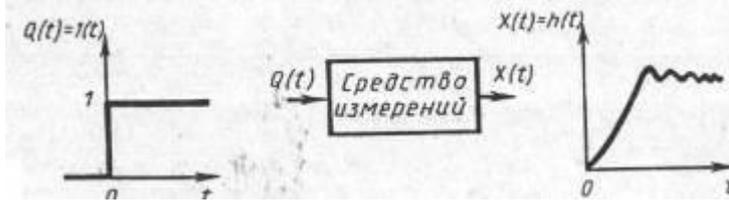
Рис. 65. Пример входного воздействия и отклика на выходе средства измерений
