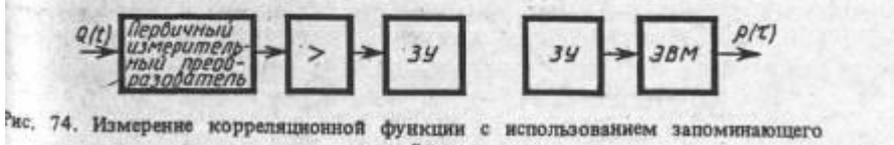
Рис. 74. Измерение корреляционной функции с использованием запоминающего устройства
