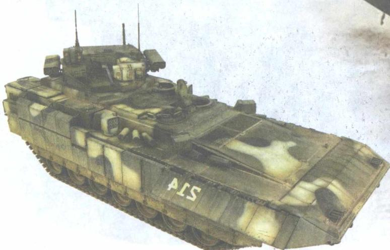
T-15 ning korpusi granata va o'qlarni o'tkazmaydigan qilib yaratilgan. Mashina korpusi so'nggi po'lat qotishmalari, kompozit materiallar va keramikadan foydalangan holda birlashtirilgan ko'p qatlamli zirhlardan yasalgan. Dastlabki ma'lumotlarga ko'ra, T-15 ning zirhlanishi tank snaryadlari, istiqbolli tanklar va raketa hujum-lariga qarshi chidamlidir.
