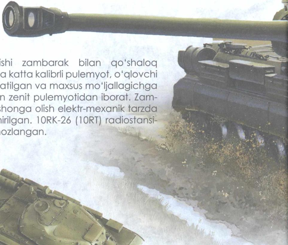
Qurollanishi zambarak bilan qo'shaloq bo'lgan bitta katta kalibrli pulemyot, o'qlovchi lyukida o'rnatilgan va maxsus mo'ljallagichga ega bo'lgan zenit pulemyotidan iborat. Zambarakda nishonga olish elektr-mexanik tarzda amalga oshirilgan. 10RK-26 (10RT) radiostansiysi bilan jihozlangan.
