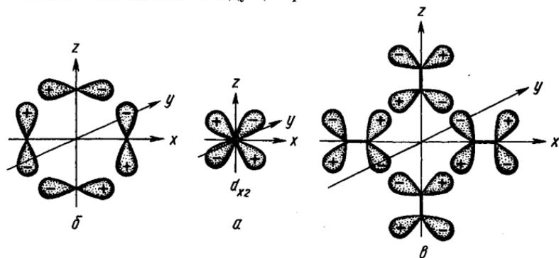
Р и с. 220.  $d_{xy}$ -Орбиталь центрального атома (а) и отвечающие ей по симметрии сочетания  $p$ - (б) и  $\pi^*$ - (в) орбиталей лигандов, приводящие к образованию молекулярных орбиталей октаэдрического комплекса
