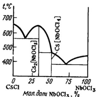
Р и с. 231. Диаграмма плавокости системы  $\text{CsCl} - \text{NbOCl}_3$
