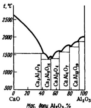
Р и с. 192. Диаграмма плавкости системы CaO - Al<sub>2</sub>O<sub>3</sub>
