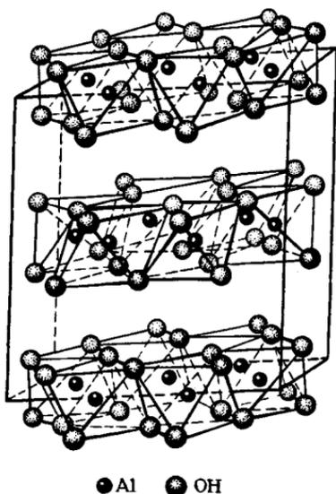
Рис. 191. Структура гидрагиллита  $Al(OH)_3$
