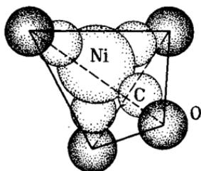
Рис. 242. Строение молекулы тетракарбонила никеля Ni(CO)<sub>4</sub>
