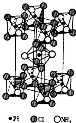
Р и с. 249. Строение кристалла  $[\text{Pt}(\text{NH}_3)_2\text{Cl}_4]$
