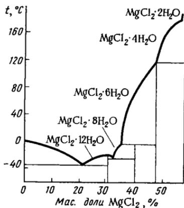
Р и с. 203. Диаграмма плавкости системы H<sub>2</sub>O — MgCl<sub>2</sub>
