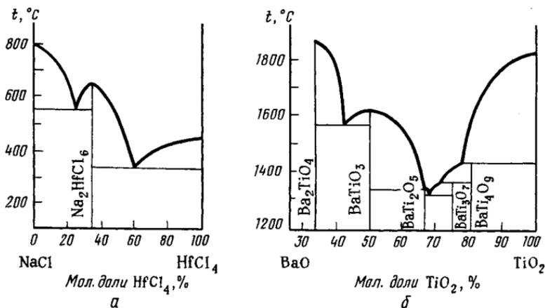
Р и с. 228. Диаграмма плавкости системы NaCl - HfCl<sub>4</sub> (а) и BaO - TiO<sub>2</sub> (б)
