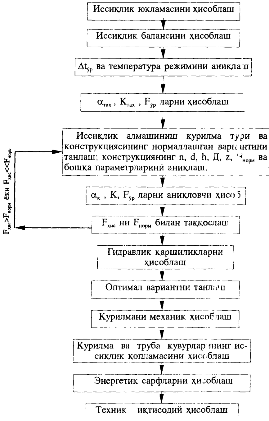
2.1 расм. Иссиқлик алмашиниш қурилмасини ҳисоблаш схемаси.
