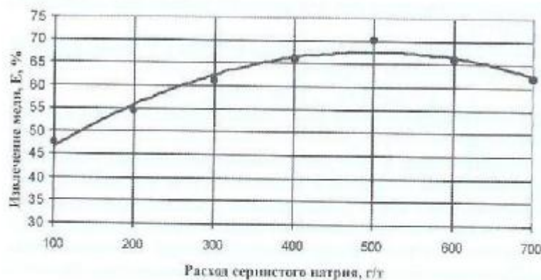
Рис. 6.6. Зависимость извлечения меди из шлаков от расхода сернистого натрия
