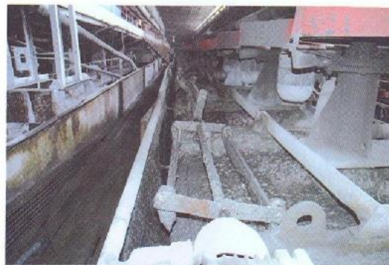
Цех флотации. Сбор концентрата после флотации шлаков медеплавильного производства
