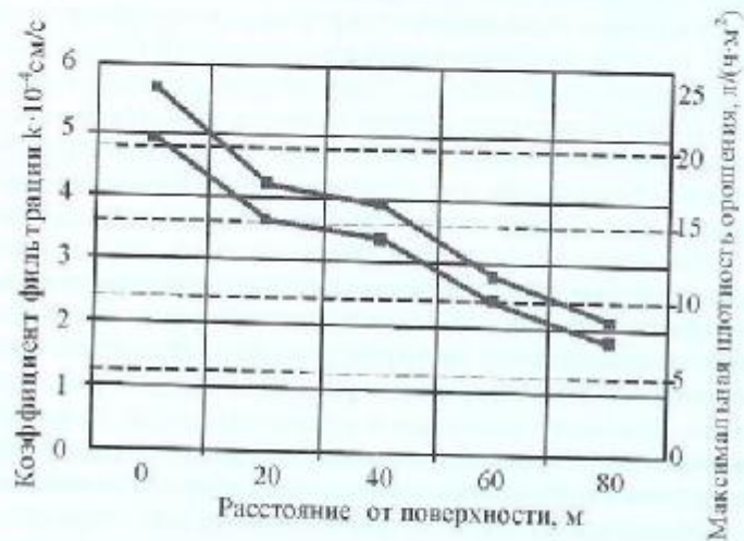
Рис. 9.7. Изменение скорости фильтрации раствора по глубине штабеля
