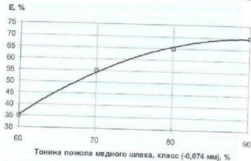
Рис. 7.2. Зависимость извлечения меди от тонины помола клинкера
