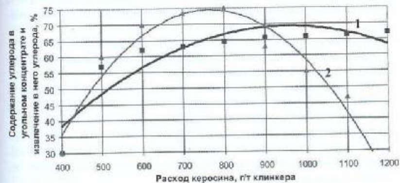
Рис. 7.4 Зависимость извлечения углерода из клинкера (E) и содержания углерода в концентрате (C) от расхода керосина
