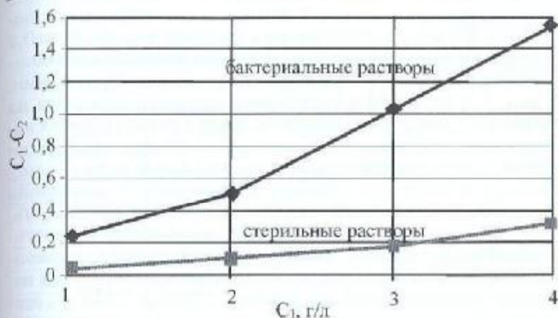
Рис. 4.22. Отклонения концентрации меди в бактериальных и стерильных растворах: по оси X отмечены концентрации меди ( C_1 ) в г/л: 1 - 0,252; 2 - 0,512; 3 - 1,024; 4 - 1,536; по оси Y ( C_1 - C_2 ) – разница между вносимыми ( C_1 ) и определяемыми ( C_2 ) концентрациями меди
