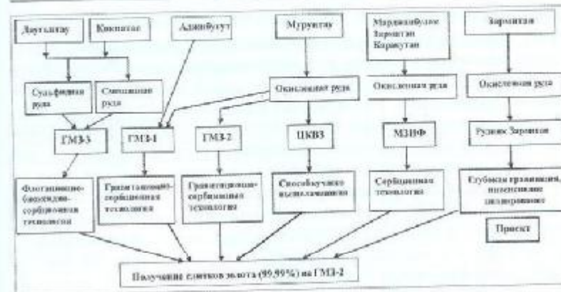
Рис. 9.12. Действующая структура переработки золотосодержащих руд [181]
