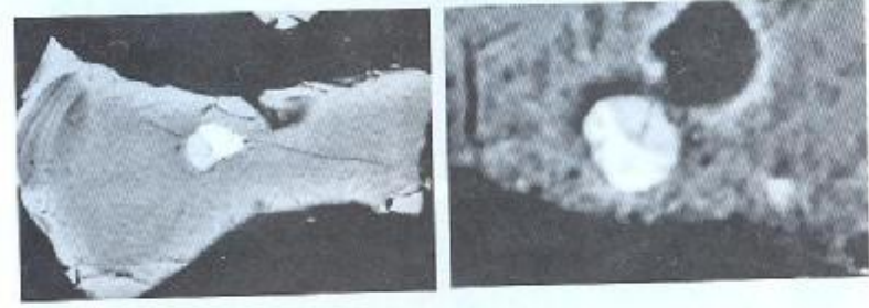
Рис. 5. Разнообразие включений в пирите. Снимки в отраженных электронах (BSE). Брикет из пробы 7010, нижние слои, после БВ, Тф. А. Включение халькопирита (светло-серый) и галенита (белый). Увеличение 1000*. Размеры площадки 102*84 мкм. Б. Включение халькопирита (светло-серый) и халькозина (белый). Увеличение 3000*. Размеры площадки 34*28 мкм
