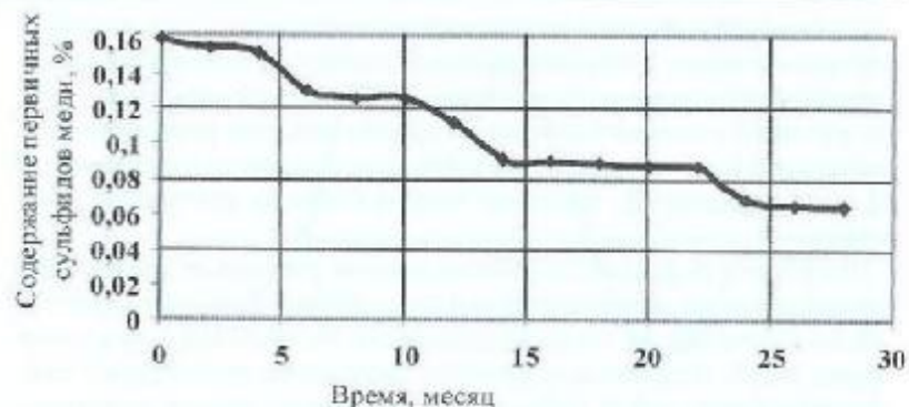
Рис. 4.21. Окисление первичных сульфидных минералов меди при бактериальном выщелачивании
