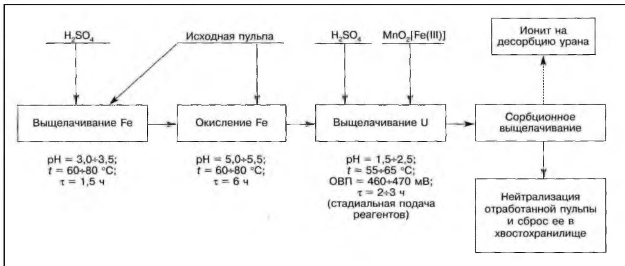
Рис.3.6 Комбинированная схема извлечения урана с использованием в качестве окислителей пиролюзита
