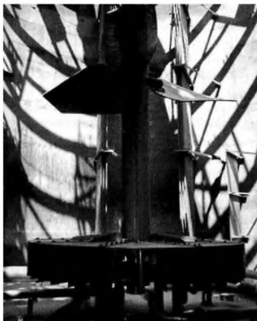
Рис.6.14. Нижняя часть диспергирующего устройства в биореакторе на заводе Касисе Кобальт Компани.
