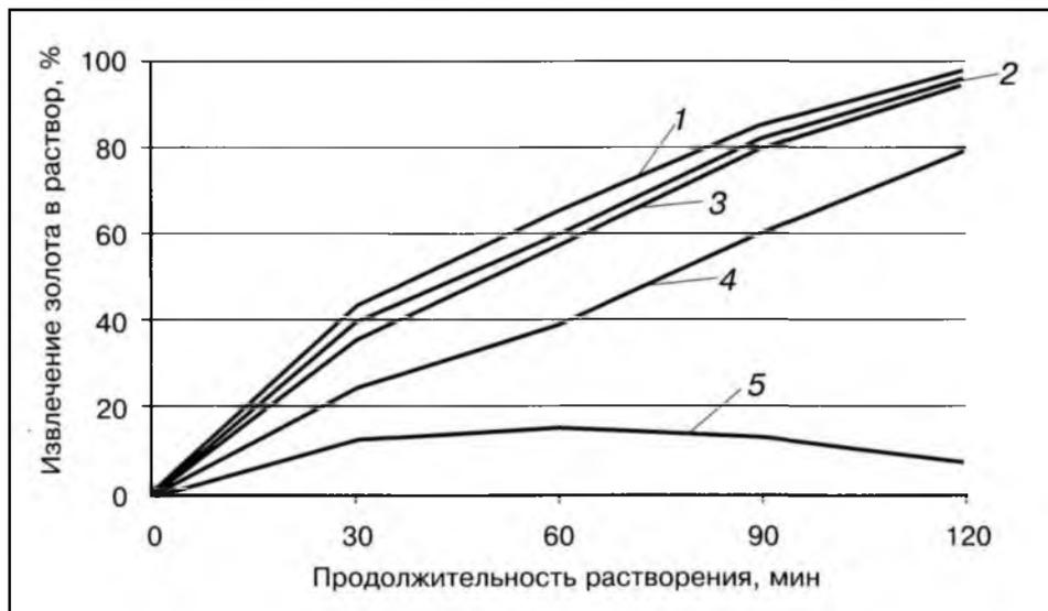
Рис.3.61. Кинетика растворения золота при различных молярных отношениях концентраций  $[\text{I}_2] / [\Gamma]$  в растворе:
