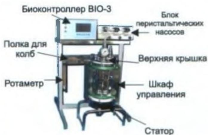
Рис.6.7. Лабораторный биореактор: слева – общий вид; справа- схема обозначений
