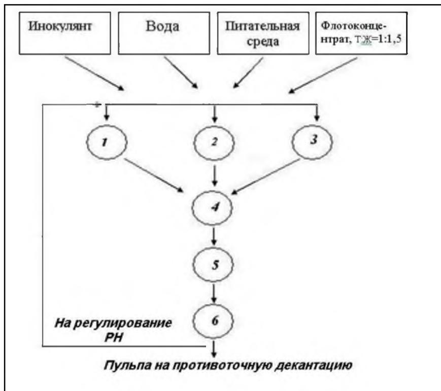
Рис.6.8. Схема лабораторной установки процесса биоокисления.
