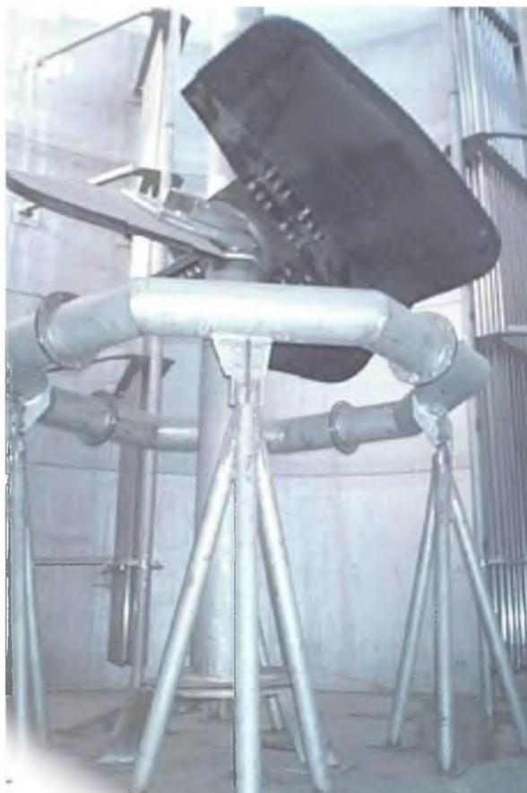
Рис.6.13. Внутренний вид биореактора на заводе Шандонг Тарзан (Китай) для бактериального выщелачивания упорных золотосодержащих концентратов:
