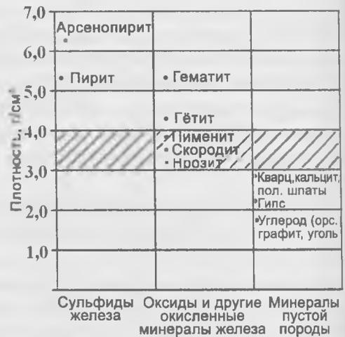
Рис. 39. Шкала обогатимости минералов гравитационным методом. Зона штриха – граничные значения плотности для разделения.
