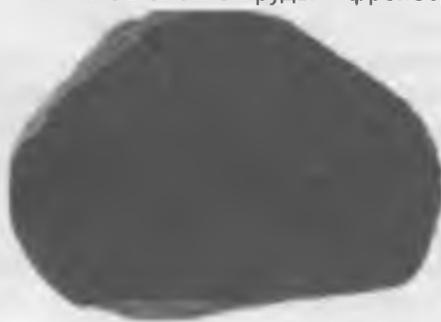
Рис. 7. Тонковкрапленная текстура сульфидов в алевролите. Месторождение Даугызтау.
