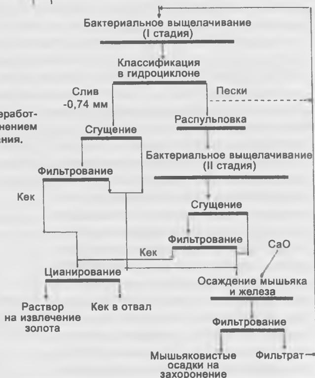
Рис. 59. Схема двухстадийного бактериального выщелачивания золотомышьякового концентрата.
