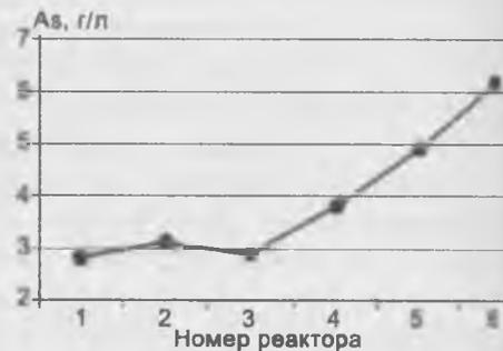
Рис. 91. График изменения концентрации мышьяка (общ.) в реакторах.
