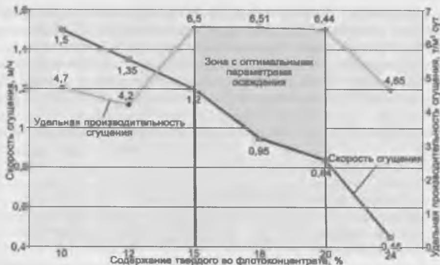
Рис. 100. Влияние плотности пульпы флотоконцентрата на показатели сгущаемости.
