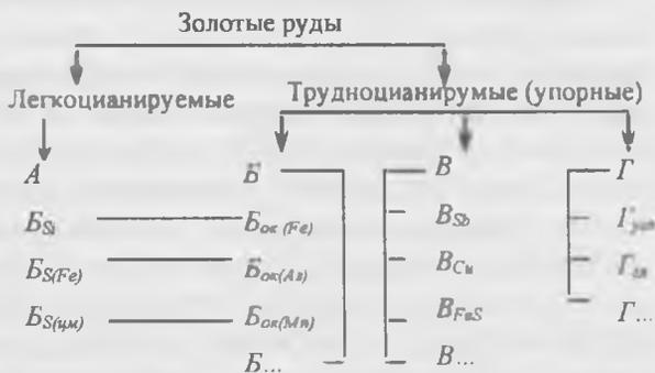
Рис. 8. Классификация золотых руд по степени и характеру их технологической упорности.
