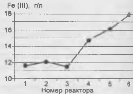
Рис. 90. График изменения концентрации железа (III) в реакторах.
