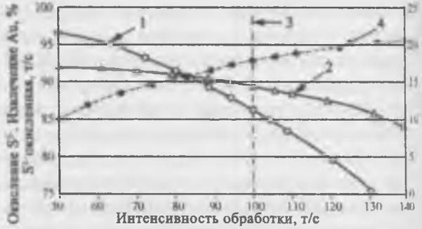
Рис. 84. Рабочие кривые процесса. 1 – окисление S<sup>2</sup>, %; 2 – извлечение Au, %; 3 – проектное значение; 4 – S<sup>2</sup> окисленная, т/с.
