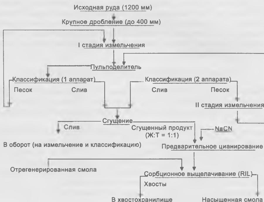
Рис. 28. Технологическая схема переработки окисленных руд на ГМЗ-3.
