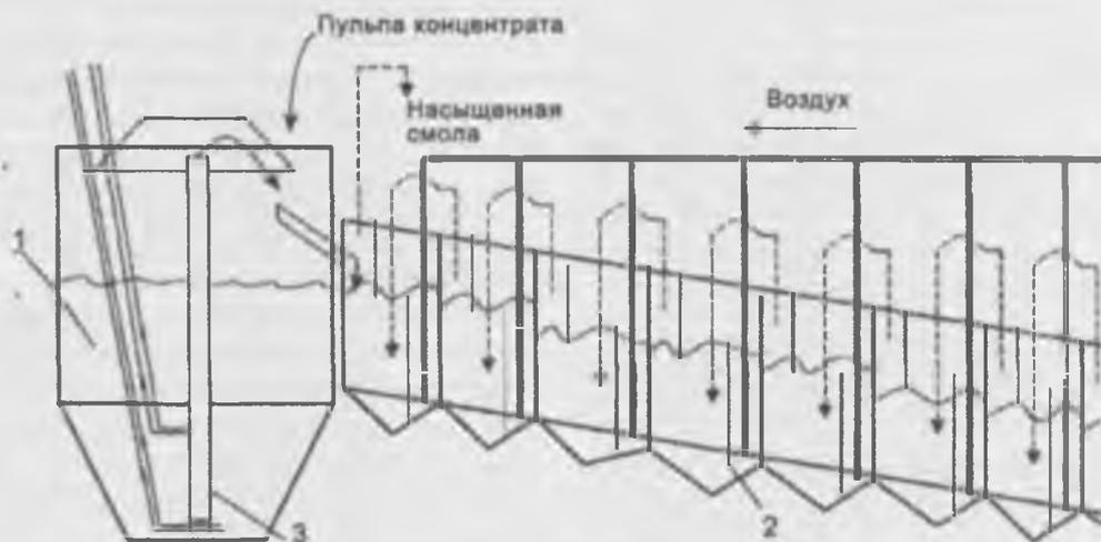
Рис. 108. Принципиальная схема установки непрерывного сорбционного выщелачивания. 1 – расходный пачук; 2 – батарея из 8-ми пачуков; 3 – эрлифт.
