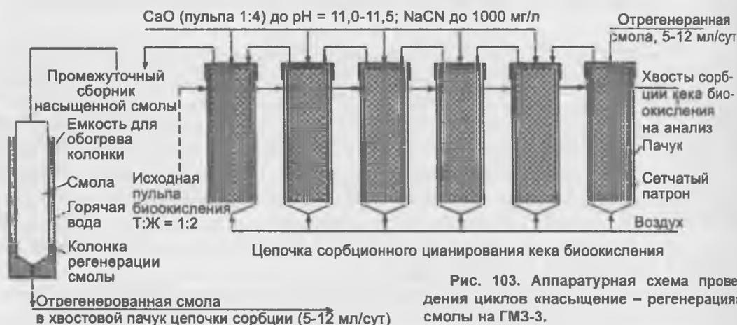
Рис. 103. Аппаратурная схема проведения циклов «насыщение – регенерация» смолы на ГМЗ-3.
