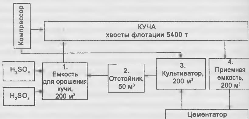
Рис. 69. Блок-схема цепи аппаратов опытного участка кучного биовыщелачивания меди из хвостов флотации МОФ.
