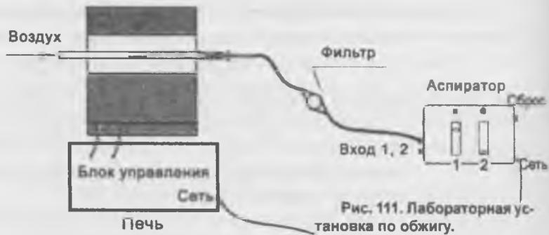
Рис. 111. Лабораторная установка по обжигу.
