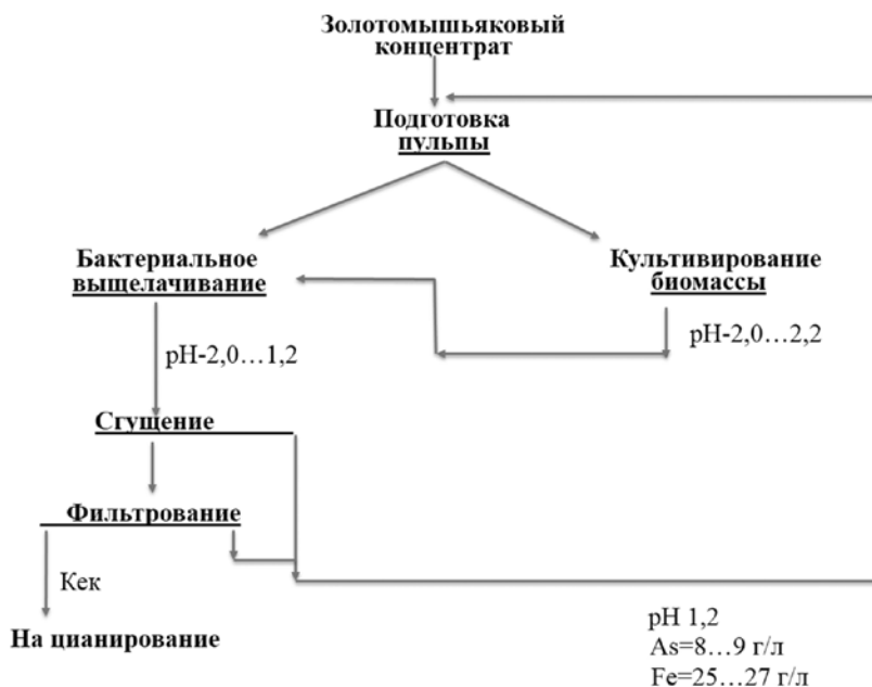
Рис. 8.2.9. Технологическая схема процесса чанового выщелачивания без очистки оборотных растворов.
