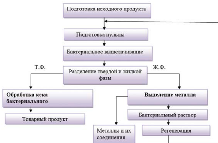
Рис. 8.2.1. Основные циклы процесса бактериального окисления сульфидных минералов.
