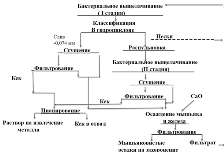
Рис. 8.2.4. Технологическая схема двухстадийного бактериального выщелачивания золотомышьякового концентрата.
