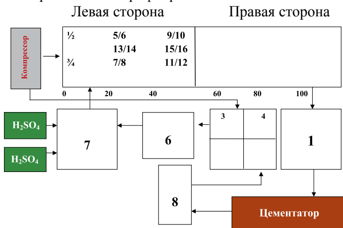
Рис. 6.3.2. Методика отбора жидких и твердых проб в процессе биовывешелачивания хвостов флотации на опытном участке.
