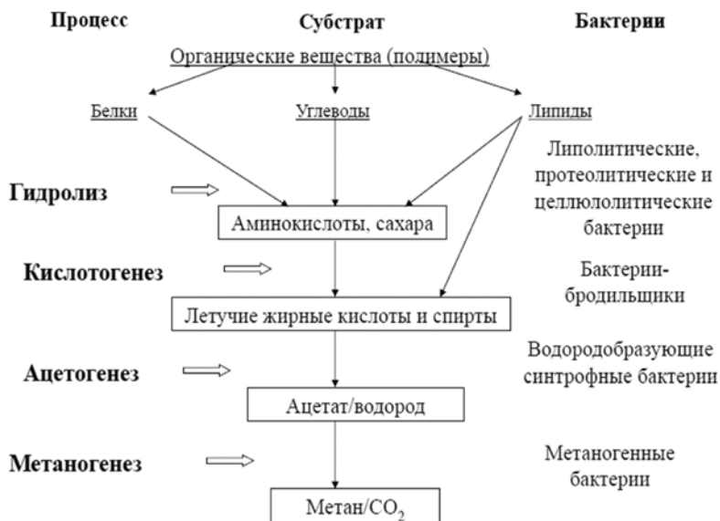
Рис. 7.1.1. Схема переработки биополимеров с помощью микрофлоры активного ила.
