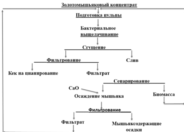
Рис. 8.2.7. Технологическая схема бактериального выщелачивания золотомышьякового концентрата с сепарированием биомассы.
