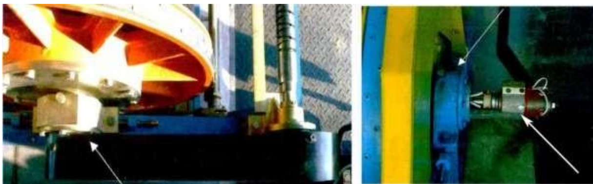
2.7-rasm. Chuqur quduqlarda qo‘llaniladigan lebyodka (a) va kabel ulash joyi (b)
