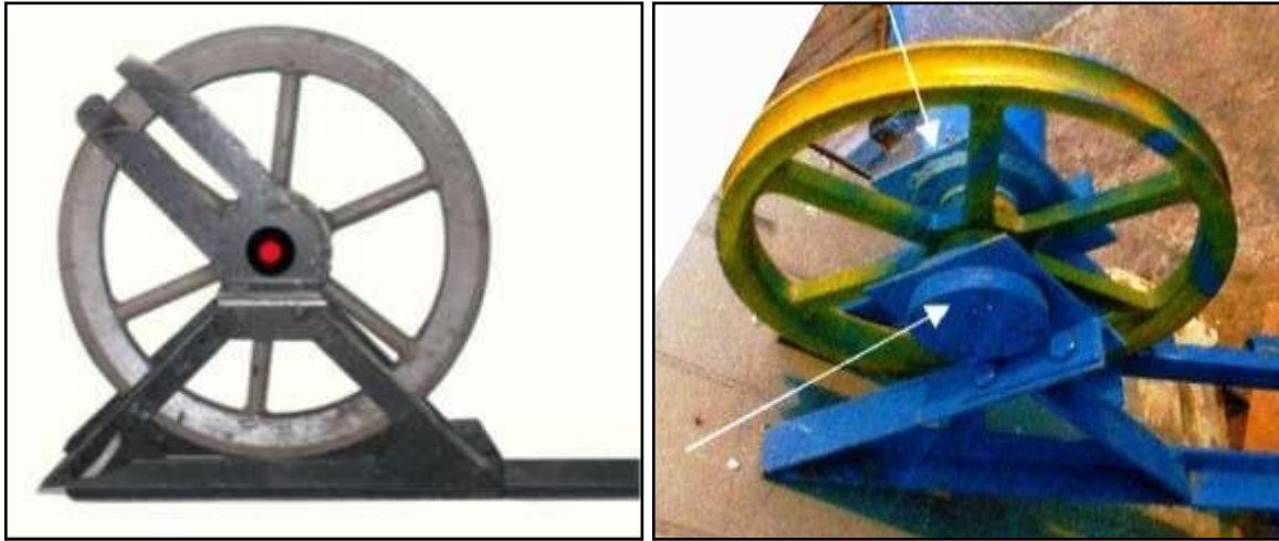
2.9 a,b - rasm. Balans bloki va uni yog‘lash joylari.
