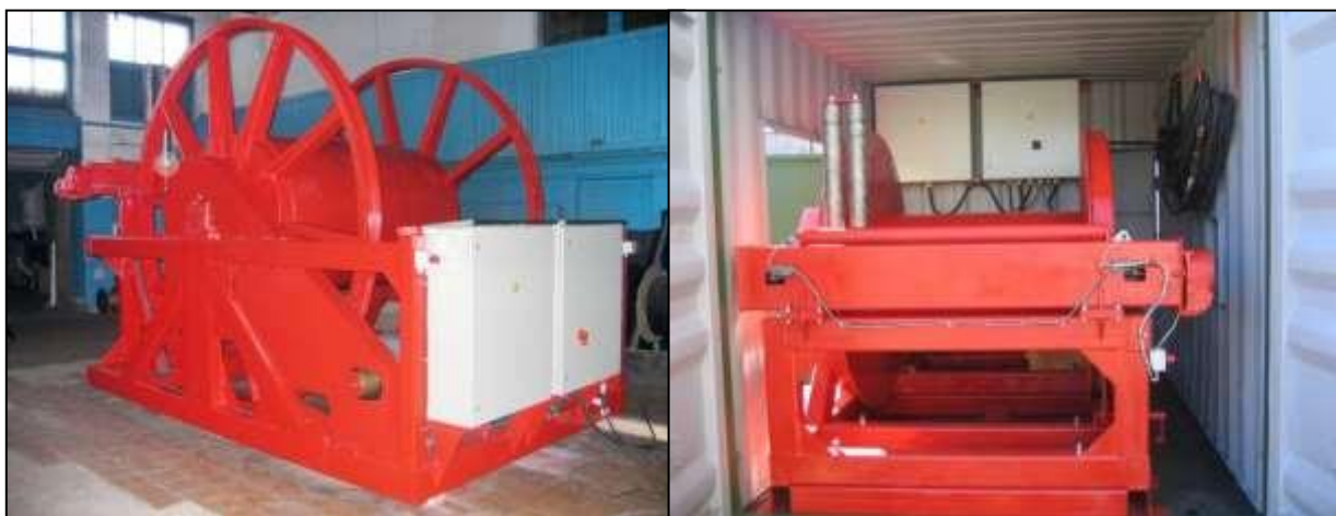
2.8 a,b – rasm. Neft va gaz quduqlarida ishlatiladigan lebyotka
