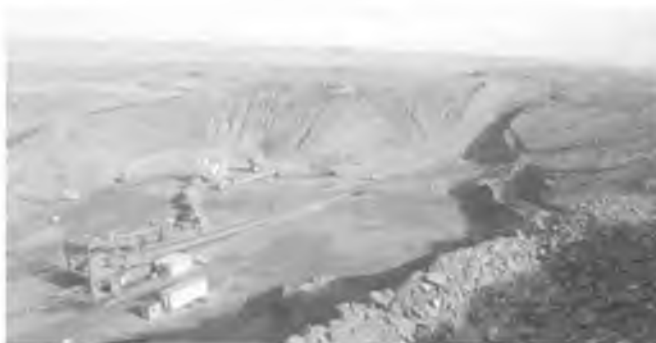
Рис.5.3. Разработка складов мобильной техникой на основе бульдозеров и фронтальных погрузчиков
