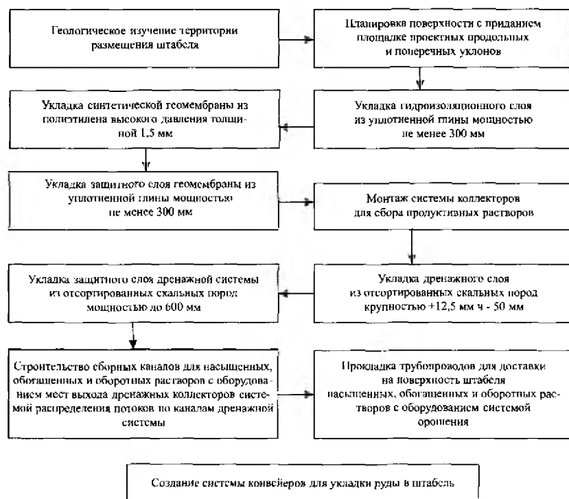
Рис.2.5. Технологическая схема формирования подушки выщелачивания и дренажной системы
