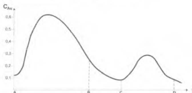
Рис. 5.12. График изменения концентрации золота в продуктивном растворе при его периодической подаче
