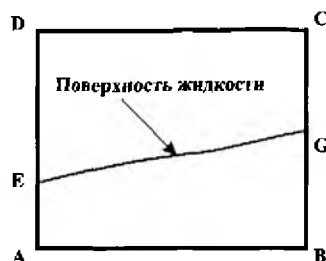
Рис.3.5. Схема элементарного блока пород в призме оползания
