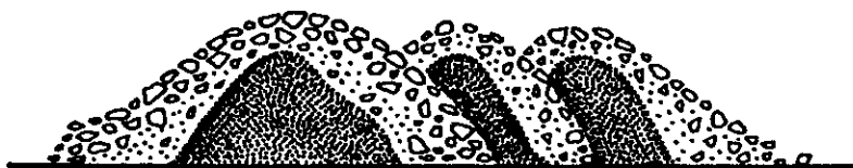
Рис. 5.7. Сегрегация частиц при формировании штабеля
