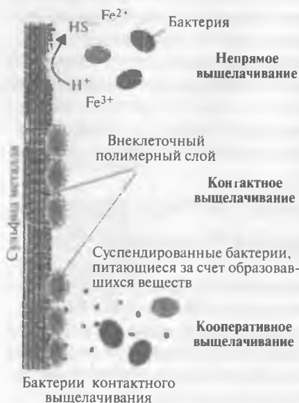
Рис. 11.5. Варианты биовыщелачивания металлического сульфида [29]
