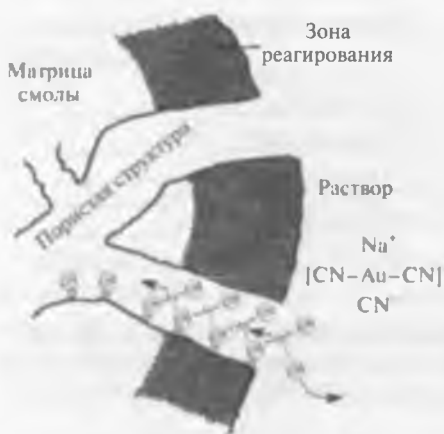
Рис. 21.17. Схема, характеризующая механизм насыщения анионообменной смолы ионами дицианаурата [55]
