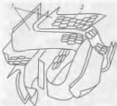
Рис. 22.4. Схематичное изображение дезорганизованной («турбостратной») микроструктуры угля: 1 – базальные плоскости (графены); 2 – кольцевые молекулы (гексагоны)
