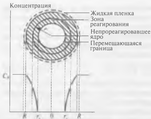
Рис. 21.23. Схема, характеризующая перемещение зоны реакции в сферической грануле ионообменной смолы [66]:
