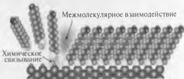
Рис. 7.6. STM-изображение ( 10 \times 10 нм) монослоя молекул этантиола на поверхности золота ( а ) и схема формирования монослоя ( б )
