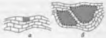
Рис. 21.4. Схематичное изображение пористой структуры, характерной для гелевых (а) и макропористых (б) ионообменных смол
