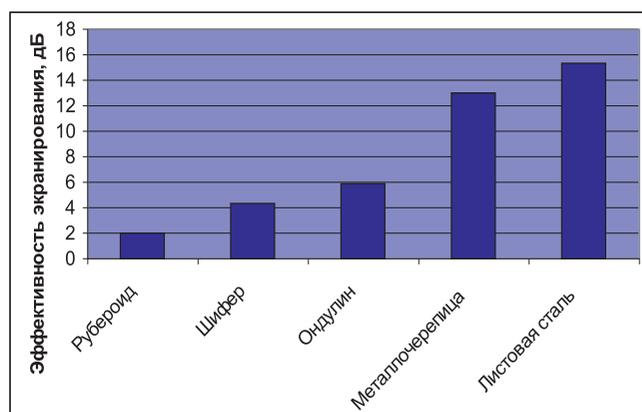
РИСУНОК 3.6. ЭФФЕКТИВНОСТЬ ЭКРАНИРОВАНИЯ МАГНИТНОГО ПОЛЯ КРОВЕЛЬНЫМИ МАТЕРИАЛАМИ
