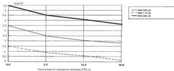
РИСУНОК 1.2. УРОВНИ НАПРЯЖЕННОСТИ МАГНИТНОГО ПОЛЯ ЛЭП (ЦЕНТР ЭЛЕКТРОМАГНИТНОЙ БЕЗОПАСНОСТИ, 1992)
