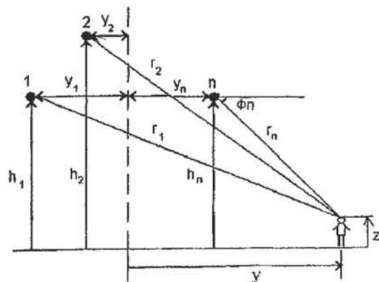
РИСУНОК 2.11. ОБОЗНАЧЕНИЯ ГАБАРИТОВ ПРИ РАСЧЕТАХ ЭМП ЛЭП
