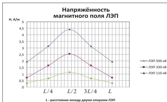
РИСУНОК 2.8. НАПРЯЖЕННОСТЬ МАГНИТНОГО ПОЛЯ ВДОЛЬ ПРОЛЕТА ТРАССЫ ЛЭП
