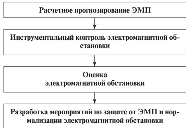
РИСУНОК 2.1. СХЕМА ПРОВЕДЕНИЯ ЭЛЕКТРОМАГНИТНОГО МОНИТОРИНГА НА УРБАНИЗИРОВАННЫХ ТЕРРИТОРИЯХ ВБЛИЗИ ЛЭП
