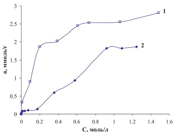
РИС. 3. ИЗОТЕРМЫ АДОРБЦИИ УКСУСНОЙ КИСЛОТЫ ИЗ ВОДНЫХ РАСТВОРОВ АКТИВИРОВАННЫМ УГЛЕМ «SIRAL 20» (1) И СОРБЕНТОМ УАС-800 (2)
