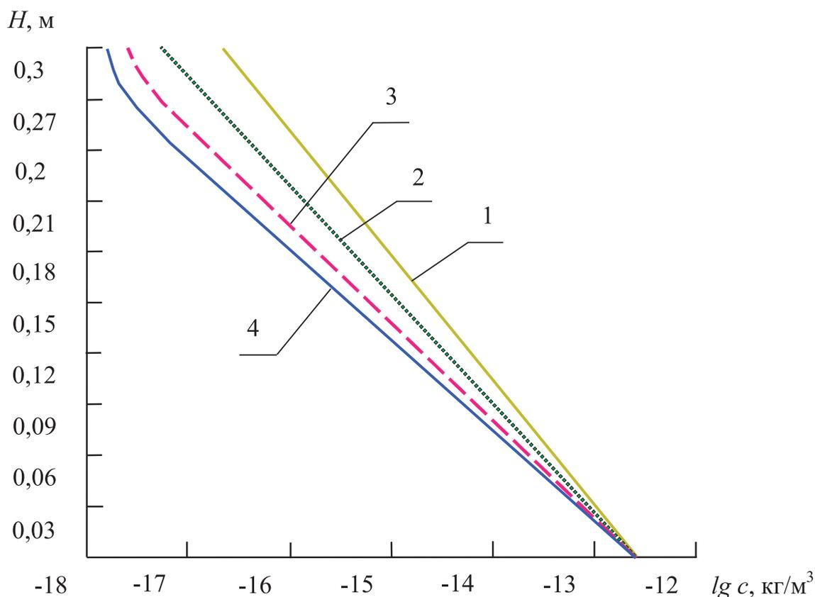
РИСУНОК – ЗАВИСИМОСТЬ КОНЦЕНТРАЦИИ РАДИОАКТИВНОГО ЙОДА В ВОДЕ ОТ ВЫСОТЫ СЛОЯ ИОНИТА В КОНЦЕ ВРЕМЕНИ РАБОЧЕГО ЦИКЛА  $\tau_p=24$  Ч: 1 – без электрического поля,  $E=0$  В/м; 2 – при напряженности электрического поля  $E=100$  В/м; 3 – при напряженности электрического поля  $E=200$  В/м; 4 – при напряженности электрического поля  $E=300$  В/м
