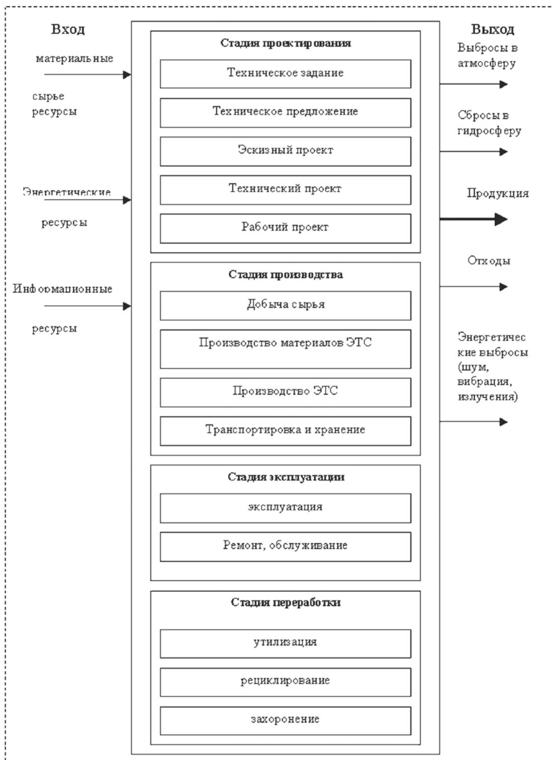
РИС. 2.9. ВХОДНЫЕ И ВЫХОДНЫЕ ПОТОКИ ЖИЗНЕННОГО ЦИКЛА ЭЛЕКТРОТЕХНИЧЕСКОЙ СИСТЕМЫ
