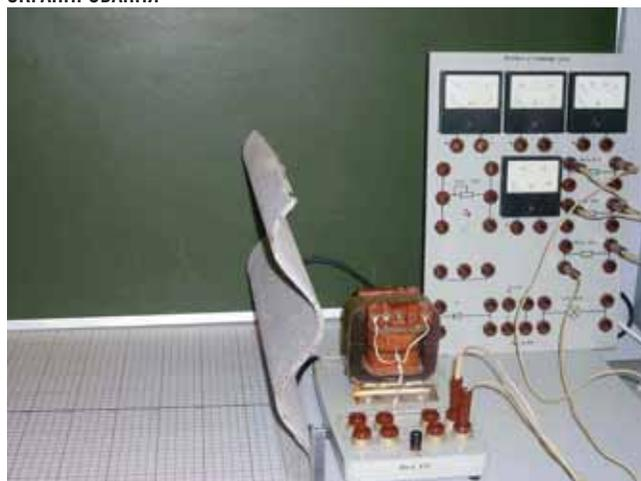
РИСУНОК 3.3. УСТАНОВКА ЭКРАНА ИЗ ШИФЕРА
