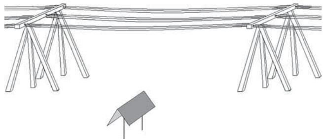
РИСУНОК 4.2. ПОПЕРЕЧНОЕ РАСПОЛОЖЕНИЕ ЭКРАНА-НАВЕСА ПО ОТНОШЕНИЮ К ПРОВОДАМ ЛЭП
