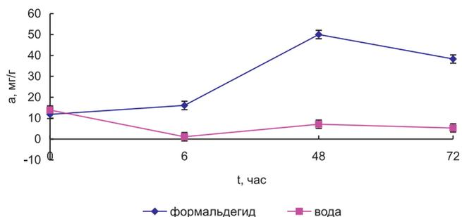
РИС. 1. КИНЕТИКА СОРБЦИИ ПАРОВ ФОРМАЛЬДЕГИДА И ВОДЫ КЛИНОПТИЛОЛИТОМ
