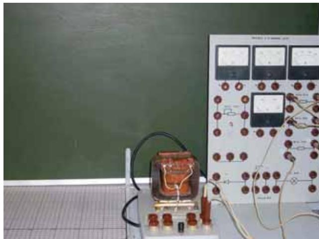
РИСУНОК 3.2. УСТАНОВКА ДЛЯ ИССЛЕДОВАНИЯ ЭФФЕКТИВНОСТИ ЭКРАНИРОВАНИЯ
