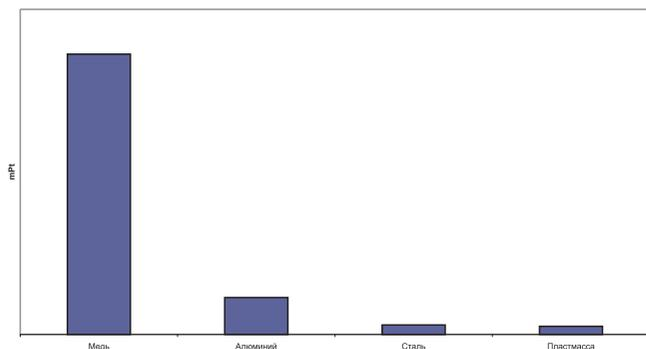
РИС. 2.11. ЭКОИНДИКАТОР 95 ПРИ ПРОИЗВОДСТВЕ 1 КГ МАТЕРИАЛА
