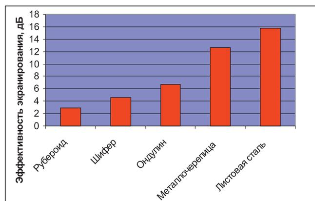
РИСУНОК 3.5. ЭФФЕКТИВНОСТЬ ЭКРАНИРОВАНИЯ ЭЛЕКТРИЧЕСКОГО ПОЛЯ КРОВЕЛЬНЫМИ МАТЕРИАЛАМИ
