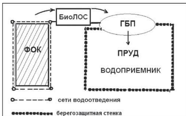
РИС. 4. СХЕМА БИОИНЖЕНЕРНОЙ СИСТЕМЫ ВОДООТВЕДЕНИЯ И ОЧИСТКИ ПОВЕРХНОСТНОГО СТОКА
