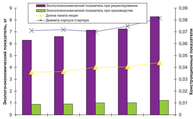
РИС. 3.10. ИЗМЕНЕНИЯ ЭКОЛОГО-ЭКОНОМИЧЕСКОГО ПОКАЗАТЕЛЯ ОТ ВАРЬИРОВАНИЯ ДЛИНЫ ПАКЕТА ЯКОРЯ И ДИАМЕТРА КОРПУСА
