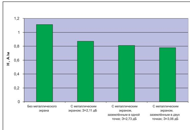
РИСУНОК 4.5. НАПРЯЖЕННОСТЬ МАГНИТНОГО ПОЛЯ ВНУТРИ СТРОИТЕЛЬНОГО ОБЪЕКТА И ЭФФЕКТИВНОСТИ ЭКРАНИРОВАНИЯ
