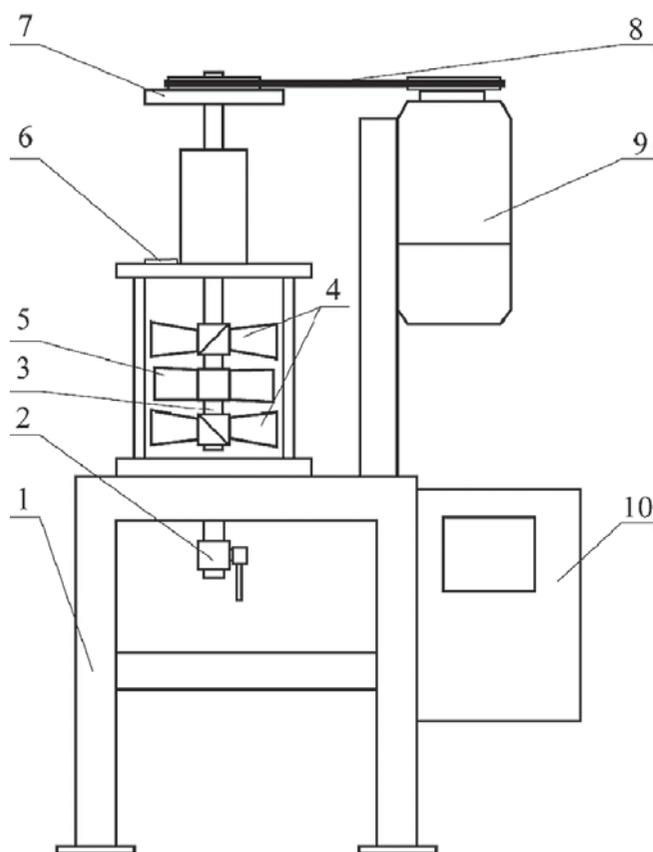
**РИС 1. СХЕМА ЛОПАСТНОГО СМЕСИТЕЛЯ ПЕРИОДИЧЕСКОГО ДЕЙСТВИЯ:**
