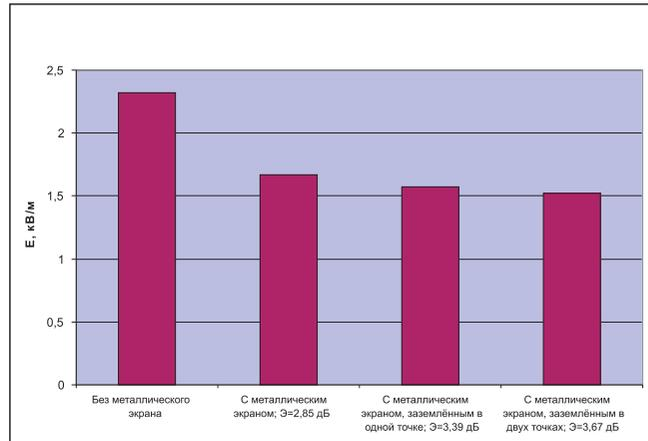
РИСУНОК 4.4. НАПРЯЖЕННОСТЬ ЭЛЕКТРИЧЕСКОГО ПОЛЯ ВНУТРИ СТРОИТЕЛЬНОГО ОБЪЕКТА И ЭФФЕКТИВНОСТИ ЭКРАНИРОВАНИЯ
