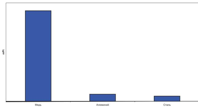
РИС. 2.13. ЭКОИНДИКАТОР 95 ПРИ РЕЦИКЛИРОВАНИИ 1 КГ МАТЕРИАЛА
