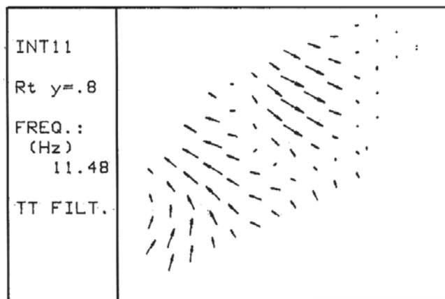
РИС. 5. РАСПРЕДЕЛЕНИЕ ВЕКТОРА АКТИВНОЙ ИНТЕНСИВНОСТИ ИНФРАЗВУКОВОГО ПОЛЯ ВНУТРИ АВТОМОБИЛЯ
