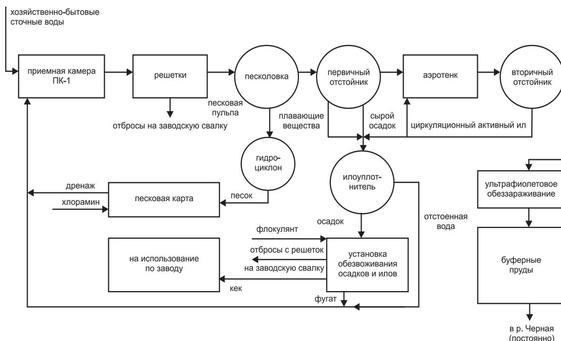
РИСУНОК 1. СХЕМА ОЧИСТКИ ХОЗЯЙСТВЕННО-БЫТОВЫХ СТОЧНЫХ ВОД ГОРОДА КИРИШИ
