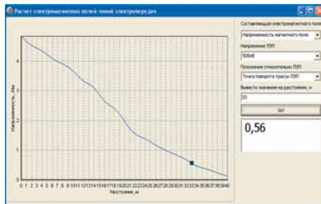
РИСУНОК 2.19. РАСЧЕТ НАПРЯЖЕННОСТИ МАГНИТНОГО ПОЛЯ ЛЭП 500 КВ ПРИ ПОВОРОТЕ ТРАССЫ НА РАССТОЯНИИ 33 М ОТ УГЛОВОЙ ОПОРЫ
