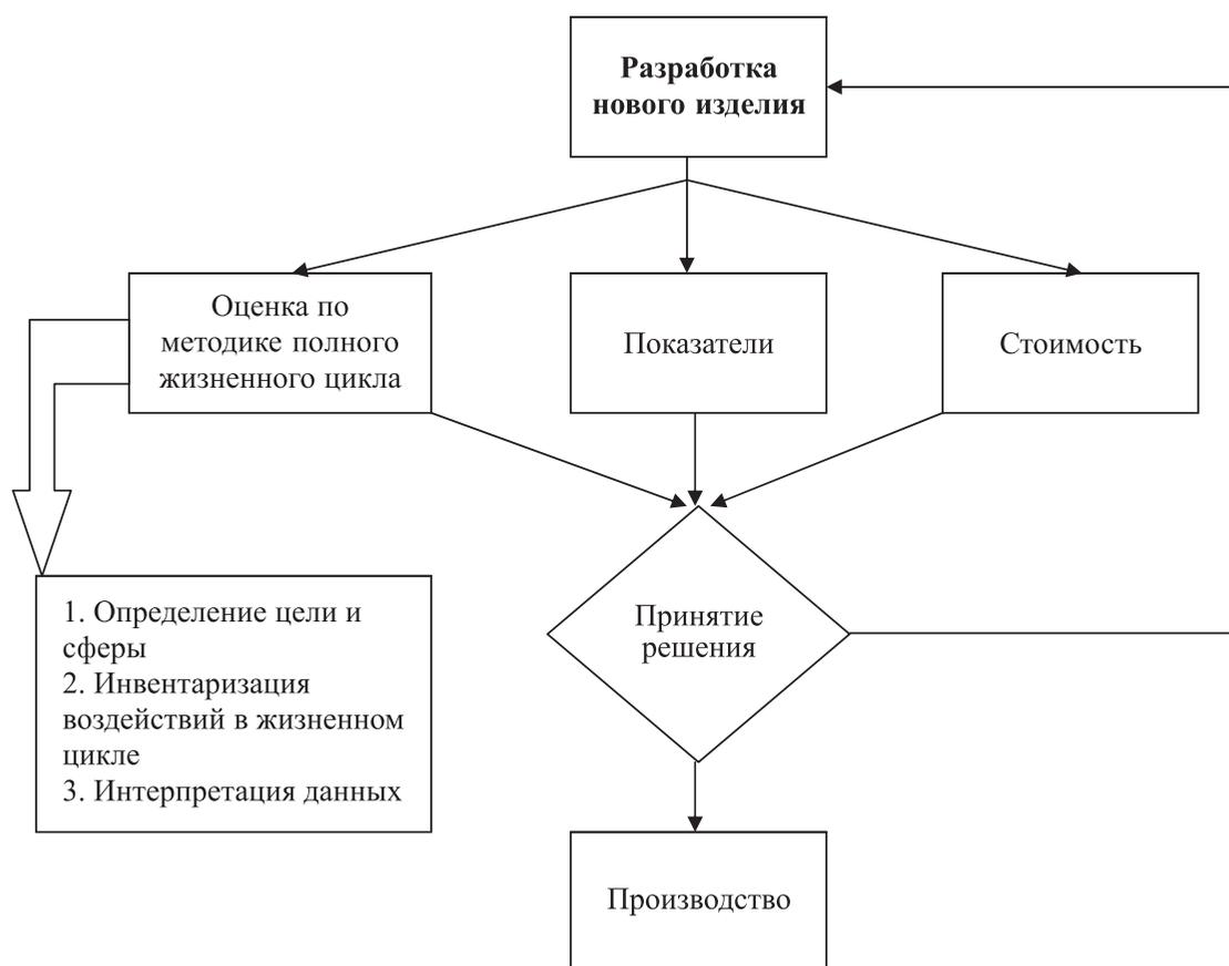
РИС. 1.1. ПРОЦЕСС РАЗРАБОТКИ НОВОЙ ТЕХНИКИ С ИСПОЛЬЗОВАНИЕМ МОДИФИЦИРОВАННОЙ МЕТОДИКИ ОЦЕНКИ ПО ПОЛНОМУ ЖИЗНЕННОМУ ЦИКЛУ
