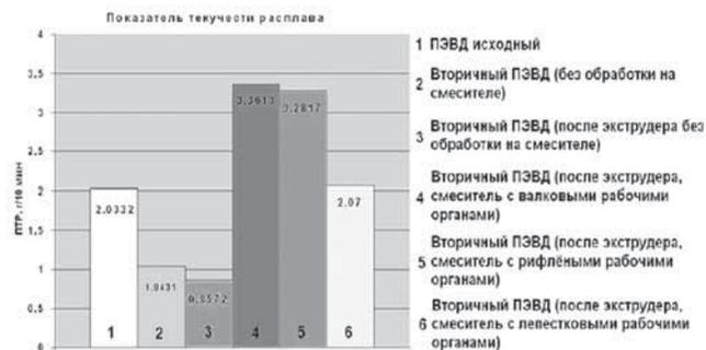
РИС. 4. СРАВНИТЕЛЬНАЯ ХАРАКТЕРИСТИКА ВОЗДЕЙСТВИЯ РАЗЛИЧНЫХ РАБОЧИХ ОРГАНОВ НА ВТОРИЧНЫЙ МАТЕРИАЛ
