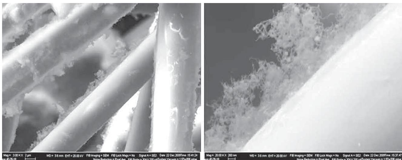
РИС. 2. КРЕМНЕЗЕМНЫЕ ВОЛОКНА ФИЛЬТРА, ПОКРЫТЫЕ СЛОЕМ УНТ
