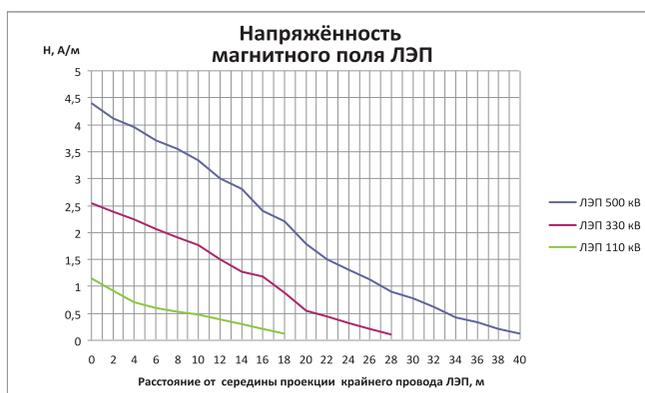
РИСУНОК 2.4. НАПРЯЖЕННОСТЬ МАГНИТНОГО ПОЛЯ ПРИ ЛИНЕЙНОМ РАСПОЛОЖЕНИИ ТРАССЫ ЛЭП
