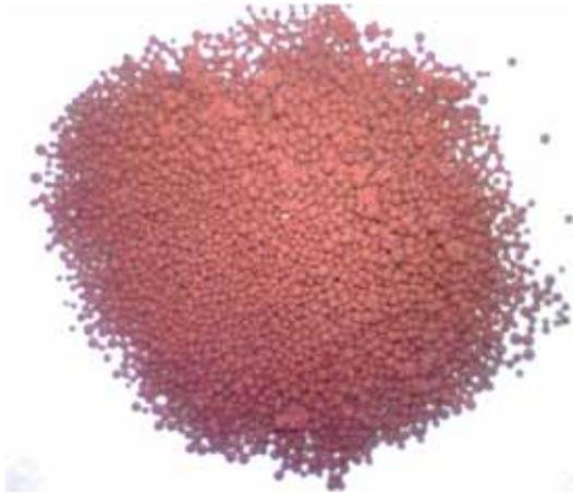
РИС. 2. ГРАНУЛЫ ПОЛИСТИРОЛА С ДОБАВЛЕНИЕМ  $Fe_2O_3$
