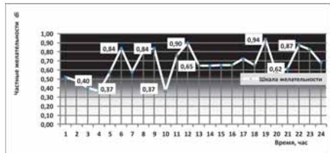
РИС. 2. ПОКАЗАТЕЛИ ЖЕЛАТЕЛЬНОСТИ ДЛЯ СУТОЧНОГО ГРАФИКА РАБОТЫ ГА ВОЛЖСКОЙ ГЭС (В РАБОЧЕМ РЕЖИМЕ)
