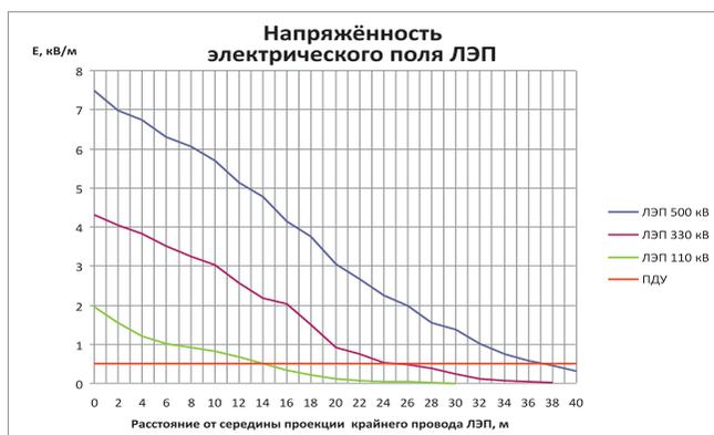
РИСУНОК 2.3. НАПРЯЖЕННОСТЬ ЭЛЕКТРИЧЕСКОГО ПОЛЯ ПРИ ЛИНЕЙНОМ РАСПОЛОЖЕНИИ ТРАССЫ ЛЭП
