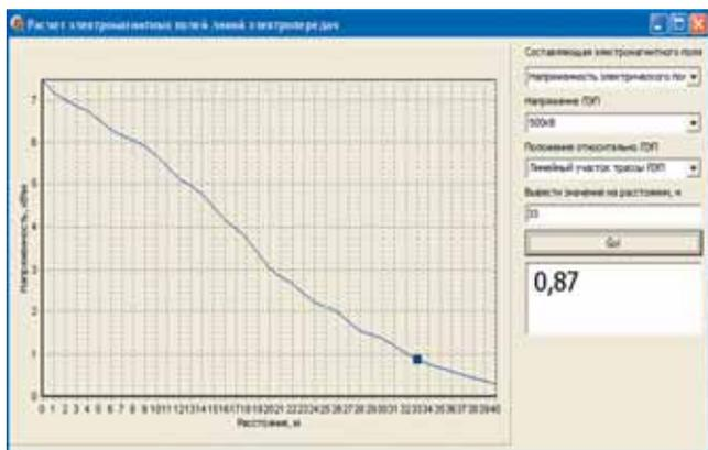
РИСУНОК 2.18. РАСЧЕТ НАПРЯЖЕННОСТИ ЭЛЕКТРИЧЕСКОГО ПОЛЯ ЛЭП 500 КВ ПРИ ПОВОРОТЕ ТРАССЫ НА РАССТОЯНИИ 33 М ОТ УГЛОВОЙ ОПОРЫ
