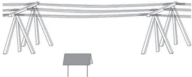
РИСУНОК 4.1. ПРОДОЛЬНОЕ РАСПОЛОЖЕНИЕ ЭКРАНА-НАВЕСА ПО ОТНОШЕНИЮ К ПРОВОДАМ ЛЭП
