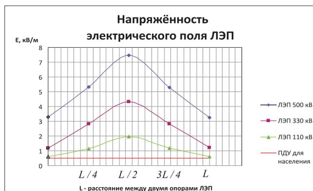
РИСУНОК 2.7. НАПРЯЖЕННОСТЬ ЭЛЕКТРИЧЕСКОГО ПОЛЯ ВДОЛЬ ПРОЛЕТА ТРАССЫ ЛЭП
