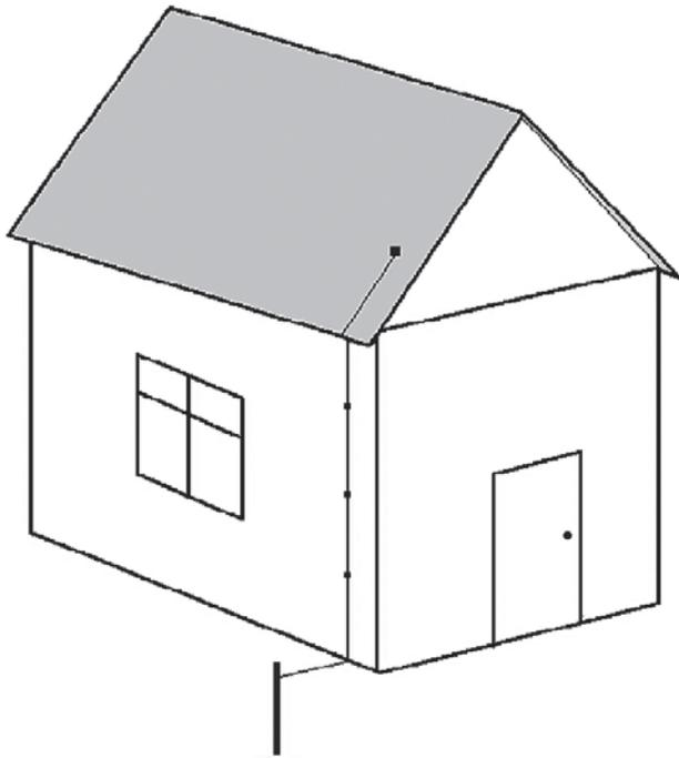
РИСУНОК 4.3. СХЕМА ЗАЗЕМЛЕНИЯ КРЫШИ ИЗ ЛИСТОВОЙ СТАЛИ В ОДНОЙ ТОЧКЕ
