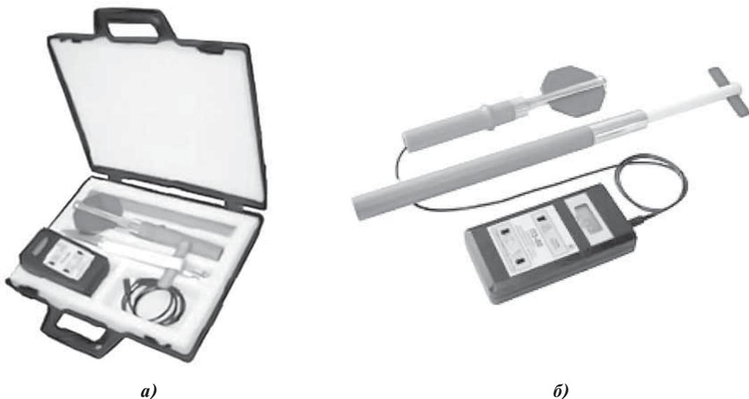
**РИСУНОК 2.2. ВНЕШНИЙ ВИД ИЗМЕРИТЕЛЯ НАПРЯЖЕННОСТИ ПОЛЯ ПРОМЫШЛЕННОЙ ЧАСТОТЫ ПЗ-50:**
