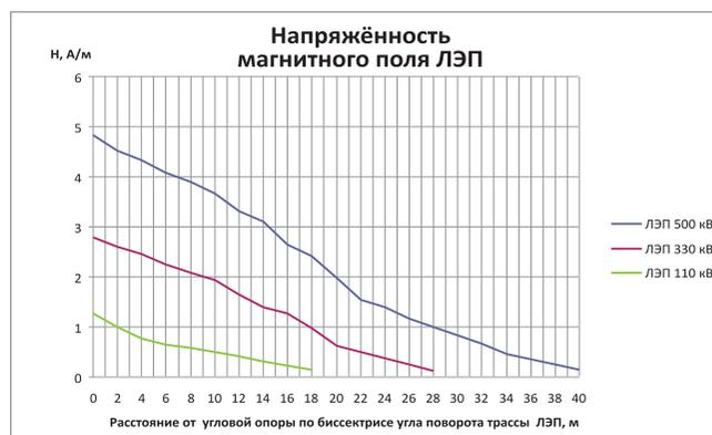
РИСУНОК 2.6. НАПРЯЖЕННОСТЬ МАГНИТНОГО ПОЛЯ ПРИ ПОВОРОТЕ ТРАССЫ ЛЭП
