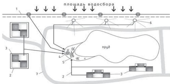
**СХЕМА СИСТЕМЫ ВОДОПОДАЧИ И ОЧИСТКИ ПОВЕРХНОСТНОГО СТОКА:**
