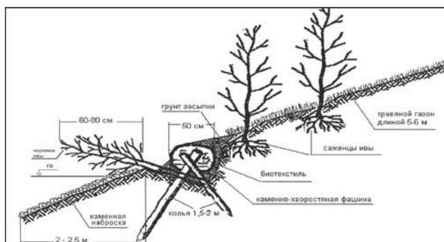
РИС. 3. СХЕМА БИОИНЖЕНЕРНОГО УКРЕПЛЕНИЯ БЕРЕГОВОГО ОТКОСА
