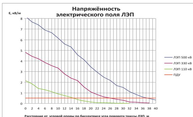
РИСУНОК 2.5. НАПРЯЖЕННОСТЬ ЭЛЕКТРИЧЕСКОГО ПОЛЯ ПРИ ПОВОРОТЕ ТРАССЫ ЛЭП
