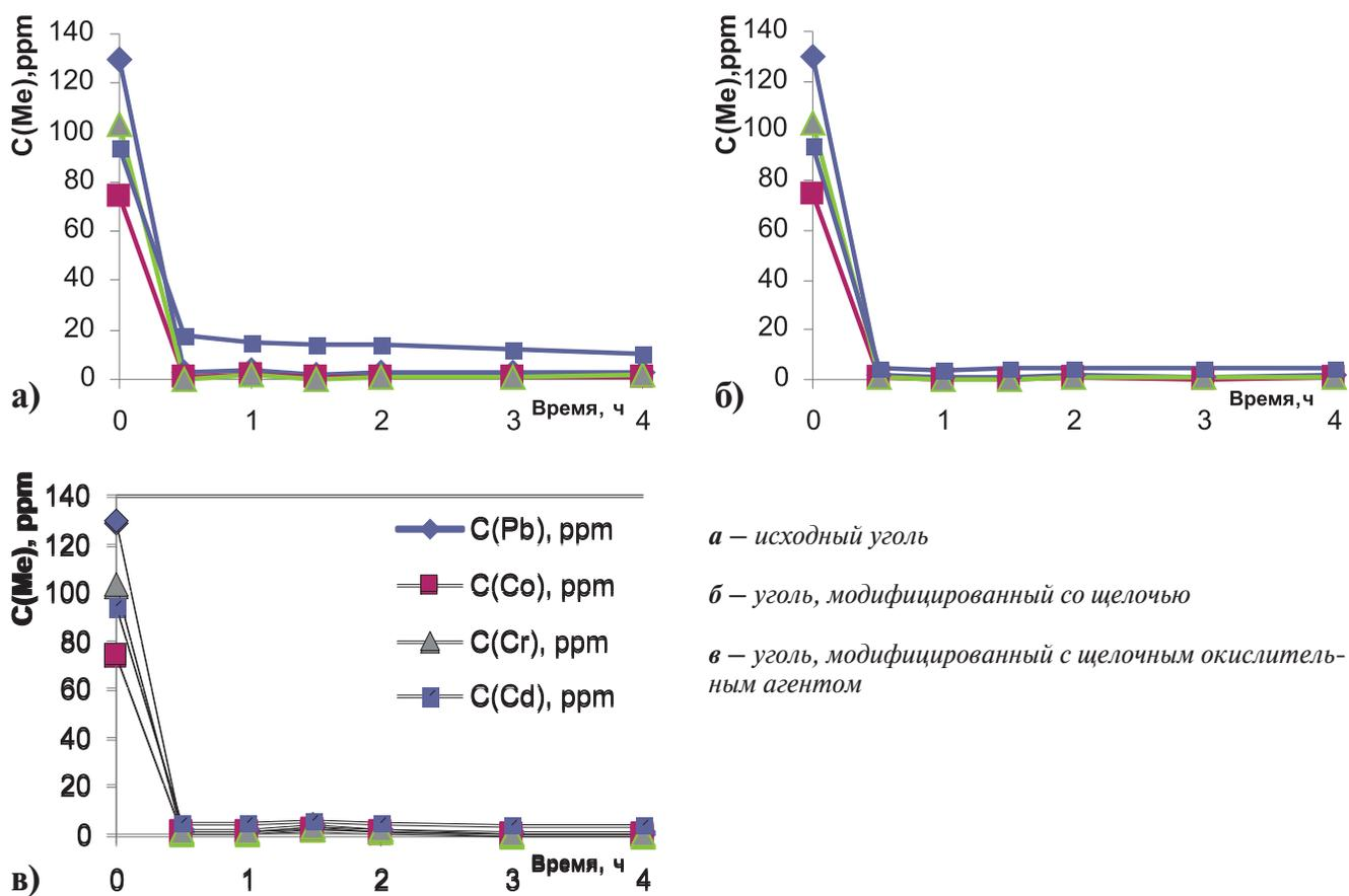
РИС.6. СОРБЦИЯ МЕТАЛЛОВ ПРЕПАРАТАМИ (ДЛЯ СЛУЧАЯ С ИСХОДНОЙ КОНЦЕНТРАЦИЕЙ МЕТАЛЛОВ 100 PPM)
