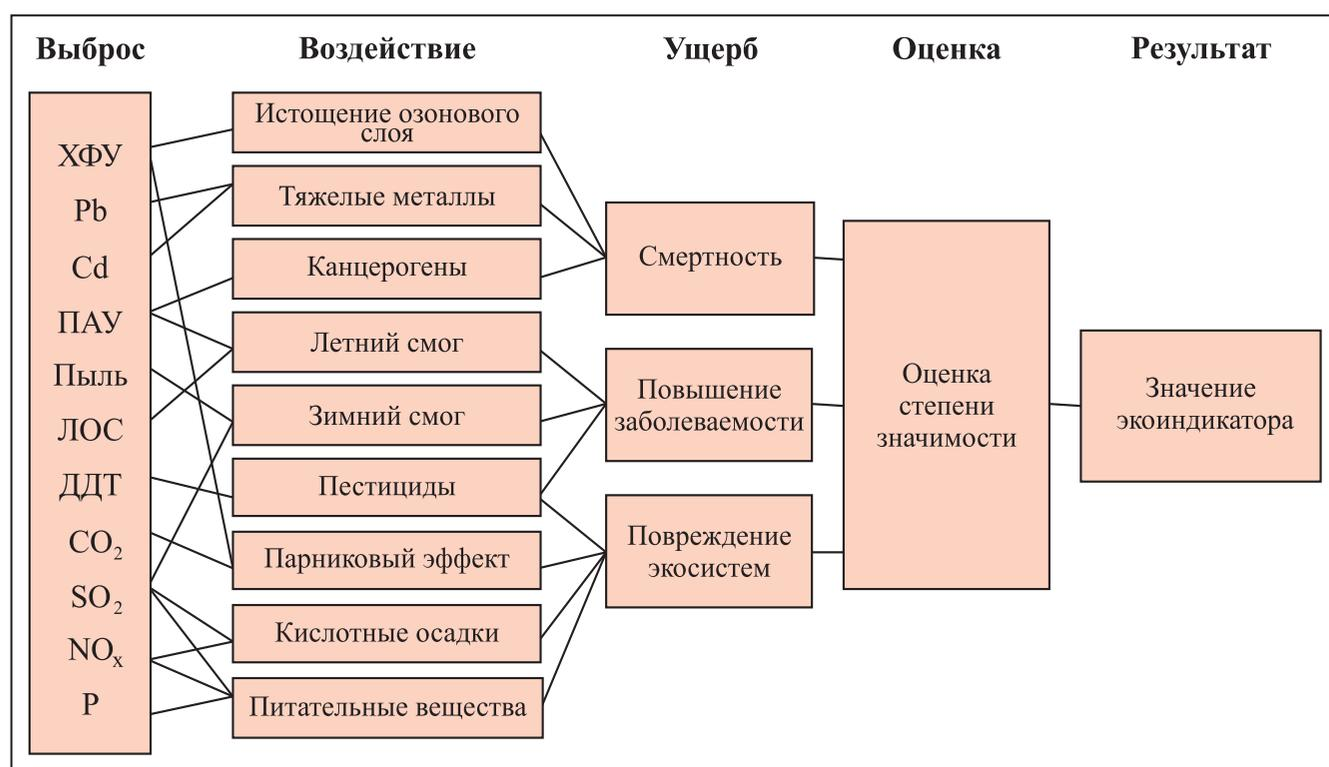
РИС. 1.2. ПРИНЦИП РАСЧЕТА ЭКОИНДИКАТОРА
