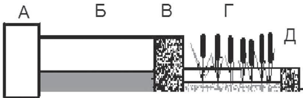
СХЕМА ОЧИСТНОГО СООРУЖЕНИЯ: А – ВОДОБОЙНЫЙ КОЛОДЕЦ, Б – ОТСТОЙНИК, В – ФИЛЬТРОВАЛЬНЫЙ БЛОК, Г – ГБП, Д – СБРОСНАЯ ПЛОТИНА
