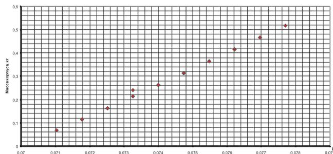
РИС. 3.3. ИЗМЕНЕНИЕ МАССЫ КОРПУСА ОТ НАРУЖНОГО ДИАМЕТРА КОРПУСА  $D_1$
