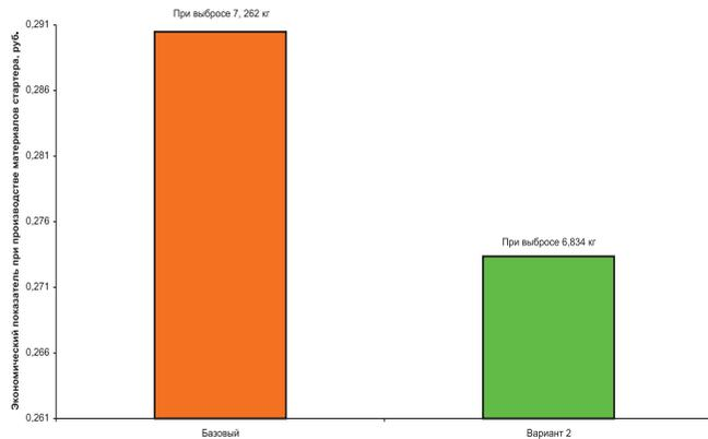
**РИС. 3.12. ЭКОЛОГО-ЭКОНОМИЧЕСКИЕ ПОКАЗАТЕЛИ СТАРТЕРА НА ЭТАПЕ ПРОИЗВОДСТВА КОНСТРУКЦИОННЫХ МАТЕРИАЛОВ**
