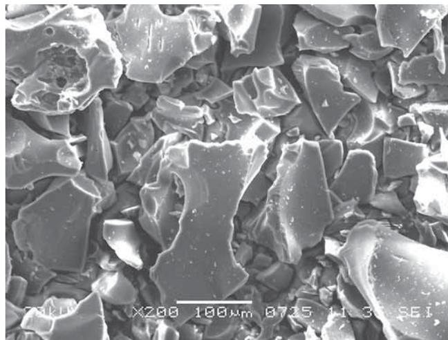
РИС. 1. ФОТОГРАФИИ ПОВЕРХНОСТИ УГЛЕРОДНОАЗОТНОГО СОРБЕНТА УАС-800
