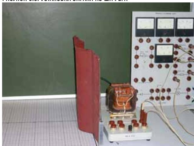
РИСУНОК 3.4. УСТАНОВКА ЭКРАНА ИЗ ОНДУЛИНА
