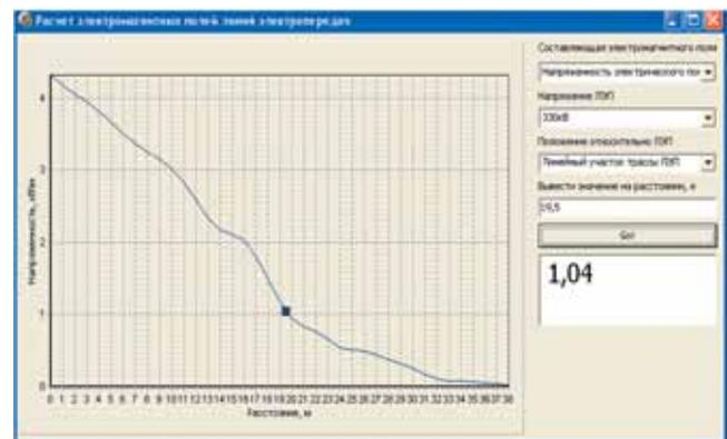
РИСУНОК 2.16. РАСЧЕТ НАПРЯЖЕННОСТИ ЭЛЕКТРИЧЕСКОГО ПОЛЯ ЛЭП 330 КВ ПРИ ЛИНЕЙНОМ ПОЛОЖЕНИИ ТРАССЫ НА РАССТОЯНИИ 19,5 М ОТ СЕРЕДИНЫ ПРОЕКЦИИ КРАЙНЕГО ПРОВОДА
