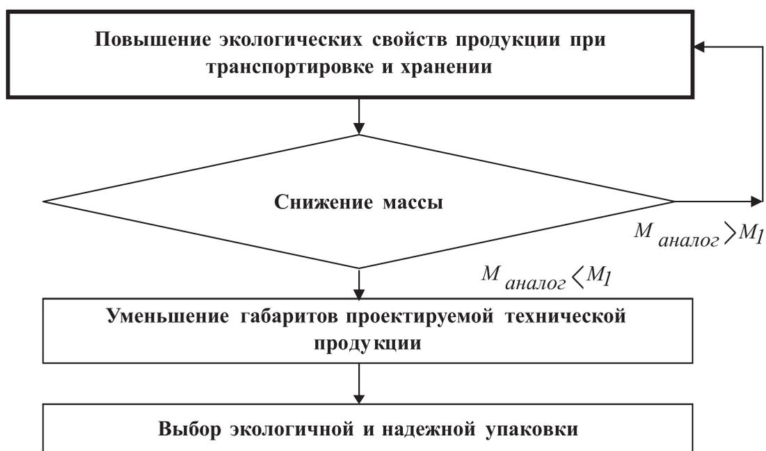
РИС. 2.4. СХЕМА УПРАВЛЕНИЯ ПРОЕКТИРОВАНИЕМ ДЛЯ РЕАЛИЗАЦИИ ЦЕЛИ ПО ПОВЫШЕНИЮ ЭКОЛОГИЧЕСКИХ СВОЙСТВ ПРОДУКЦИИ ПРИ ТРАНСПОРТИРОВКЕ И ХРАНЕНИИ
