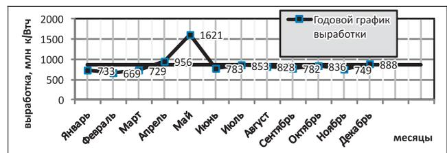
РИС. 3. ГРАФИК ГОДОВОЙ ВЫРАБОТКИ ЭЛЕКТРОЭНЕРГИИ ВОЛЖСКОЙ ГЭС ЗА 2011 Г.
