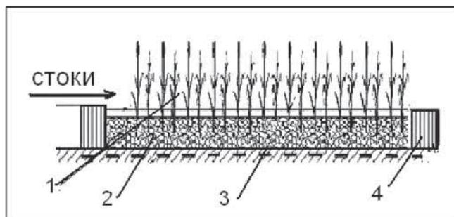
РИС.1. СХЕМА ГИДРОБОТАНИЧЕСКОЙ ПЛОЩАДКИ:
