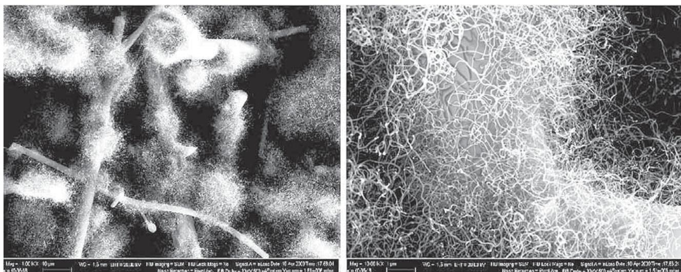
РИС. 1. КРЕМНИЕВЫЕ ВОЛОКНА ФИЛЬТРА, ПОКРЫТЫЕ СЛОЕМ УНТ
