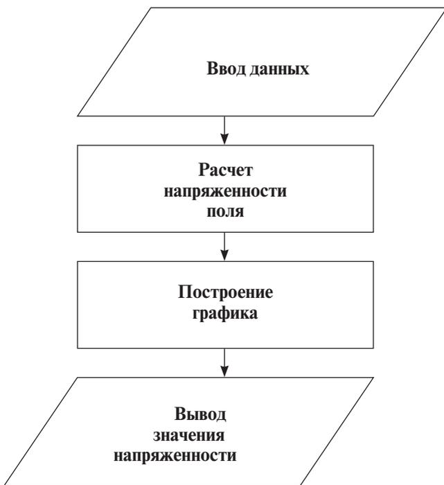
РИСУНОК 2.14. АЛГОРИТМ РАСЧЕТА ЭМП ЛЭП
