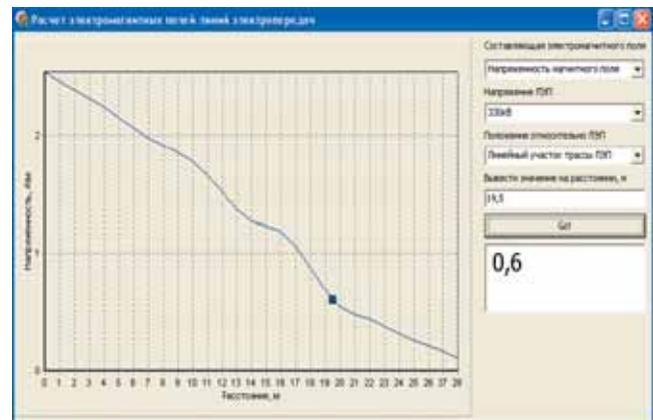
РИСУНОК 2.17. РАСЧЕТ НАПРЯЖЕННОСТИ МАГНИТНОГО ПОЛЯ ЛЭП 330 КВ ПРИ ЛИНЕЙНОМ ПОЛОЖЕНИИ ТРАССЫ НА РАССТОЯНИИ 19,5 М ОТ СЕРЕДИНЫ ПРОЕКЦИИ КРАЙНЕГО ПРОВОДА
