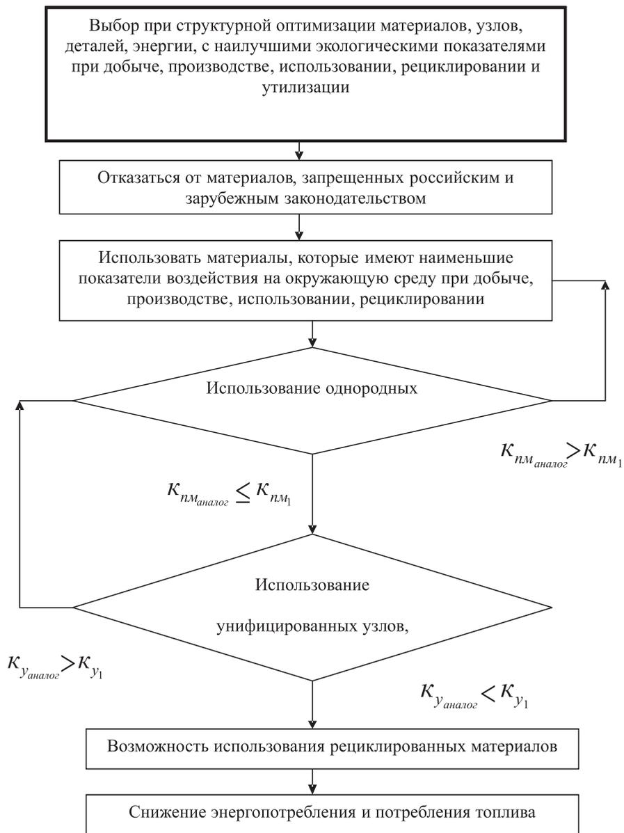
РИС. 2.1. СХЕМА УПРАВЛЕНИЯ ПРОЕКТИРОВАНИЕМ ДЛЯ РЕАЛИЗАЦИИ ЦЕЛИ ПО ВЫБОРУ ПРИ СТРУКТУРНОЙ ОПТИМИЗАЦИИ МАТЕРИАЛОВ, УЗЛОВ, ДЕТАЛЕЙ, ЭНЕРГИИ, С НАИЛУЧШИМИ ЭКОЛОГИЧЕСКИМИ ПОКАЗАТЕЛЯМИ ПРИ ДОБЫЧЕ, ПРОИЗВОДСТВЕ, ИСПОЛЬЗОВАНИИ, РЕЦИКЛИРОВАНИИ И УТИЛИЗАЦИИ
