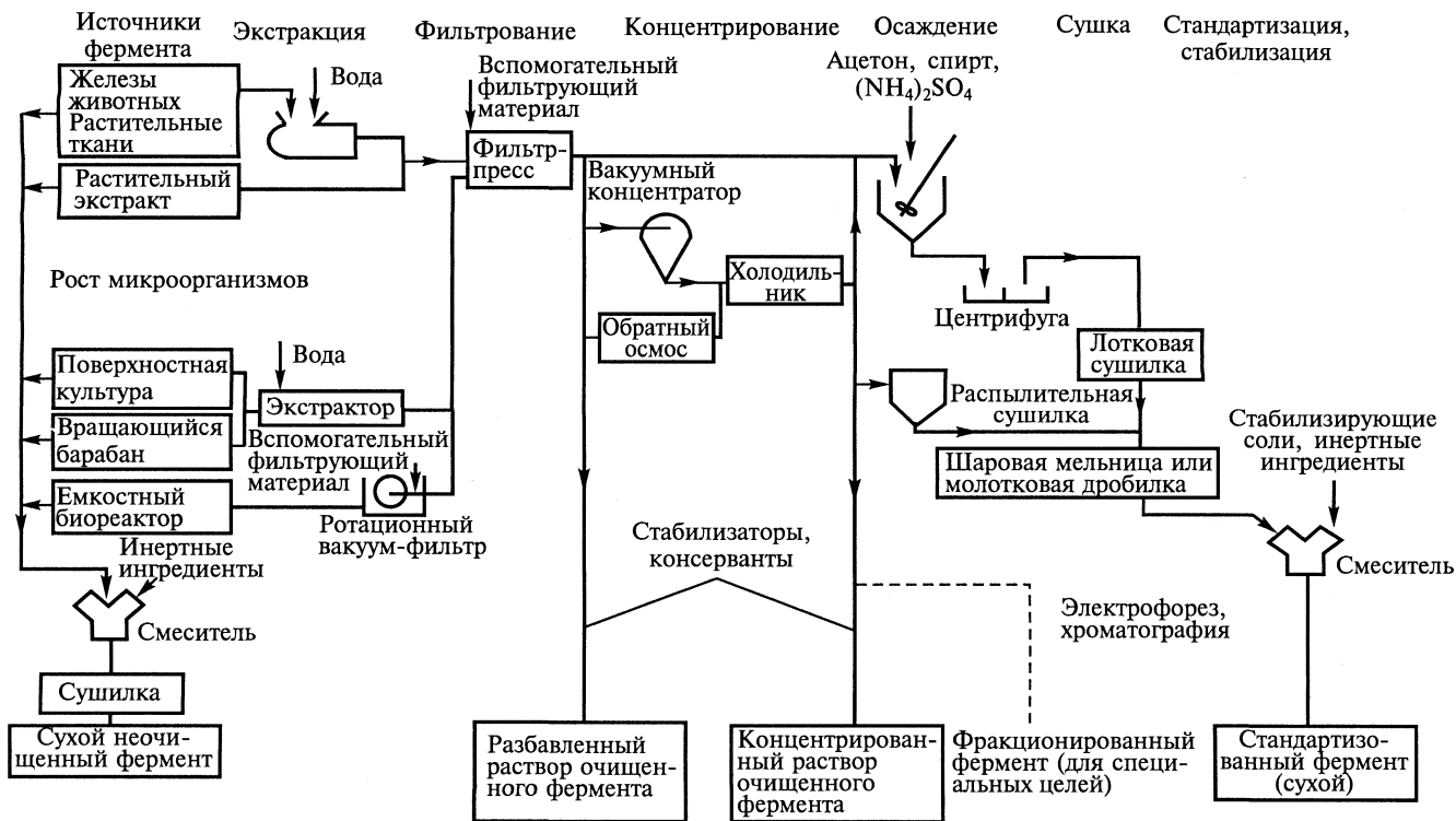
Рис. 4.3. Схема получения ферментных препаратов из культур микроорганизмов (по Дж. Бейли, Д. Оллис, 1989)
