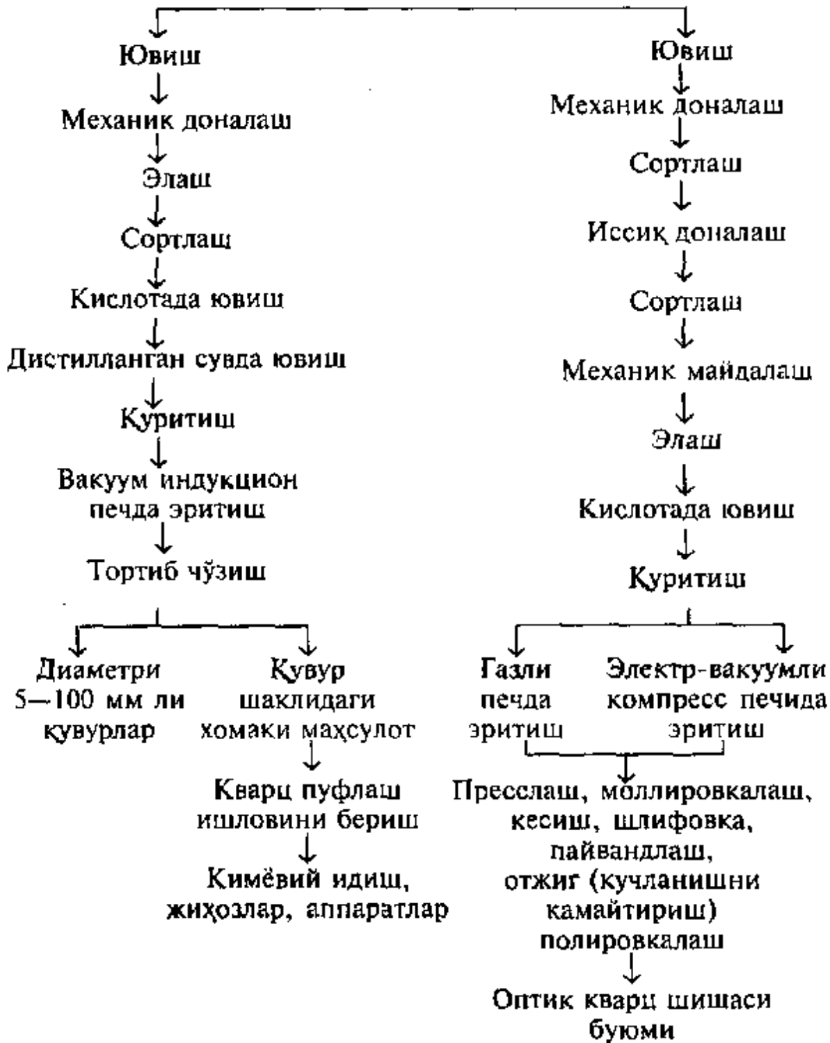
14- расм. Шаффоф кварц шишаси асосида буюмлар ишлаб чиқаришнинг технологик схемаси.
