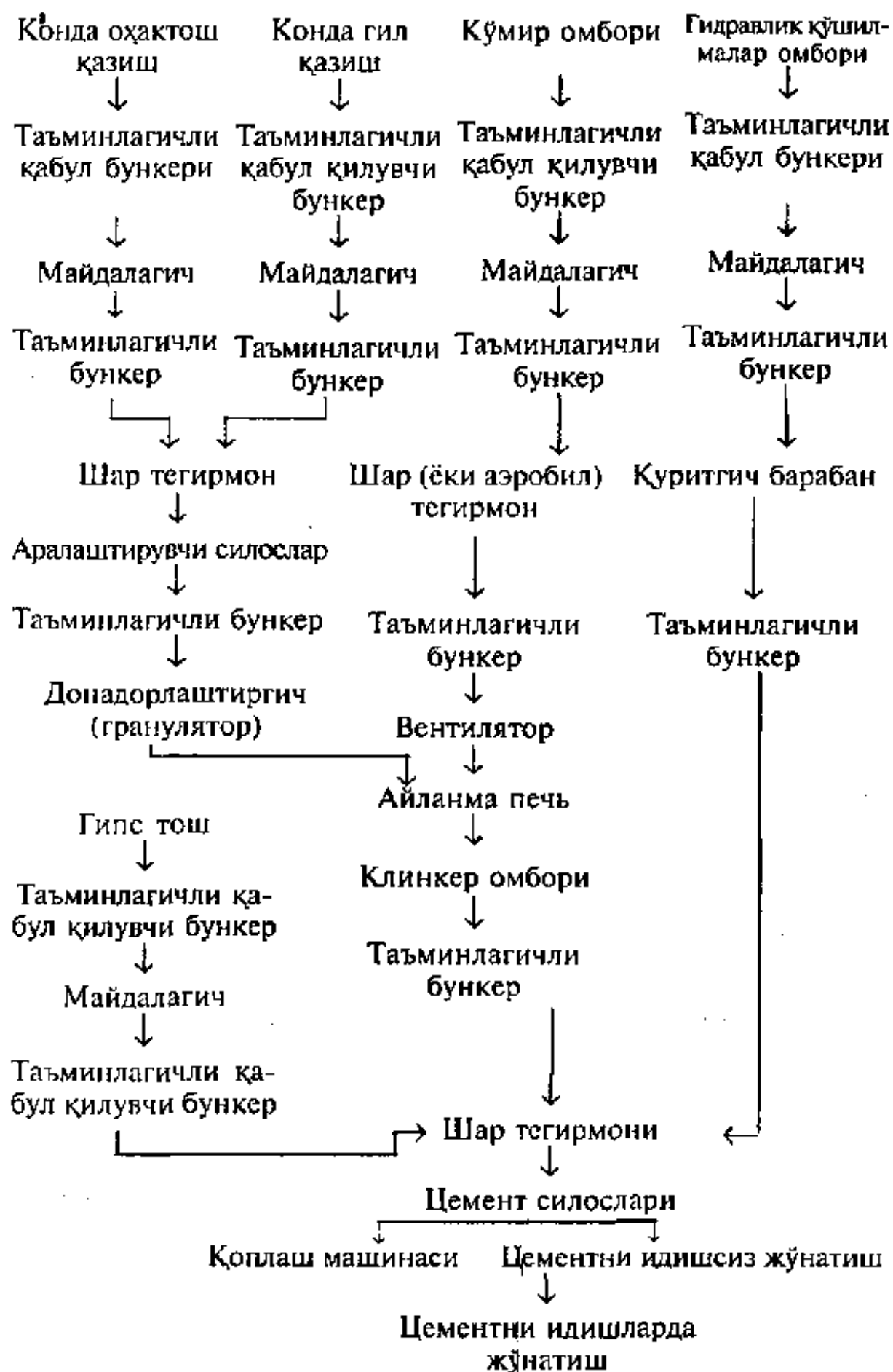
20- расм. Қуруқ усулда портландцемент ишлаб чиқариш технологияси схемаси.
