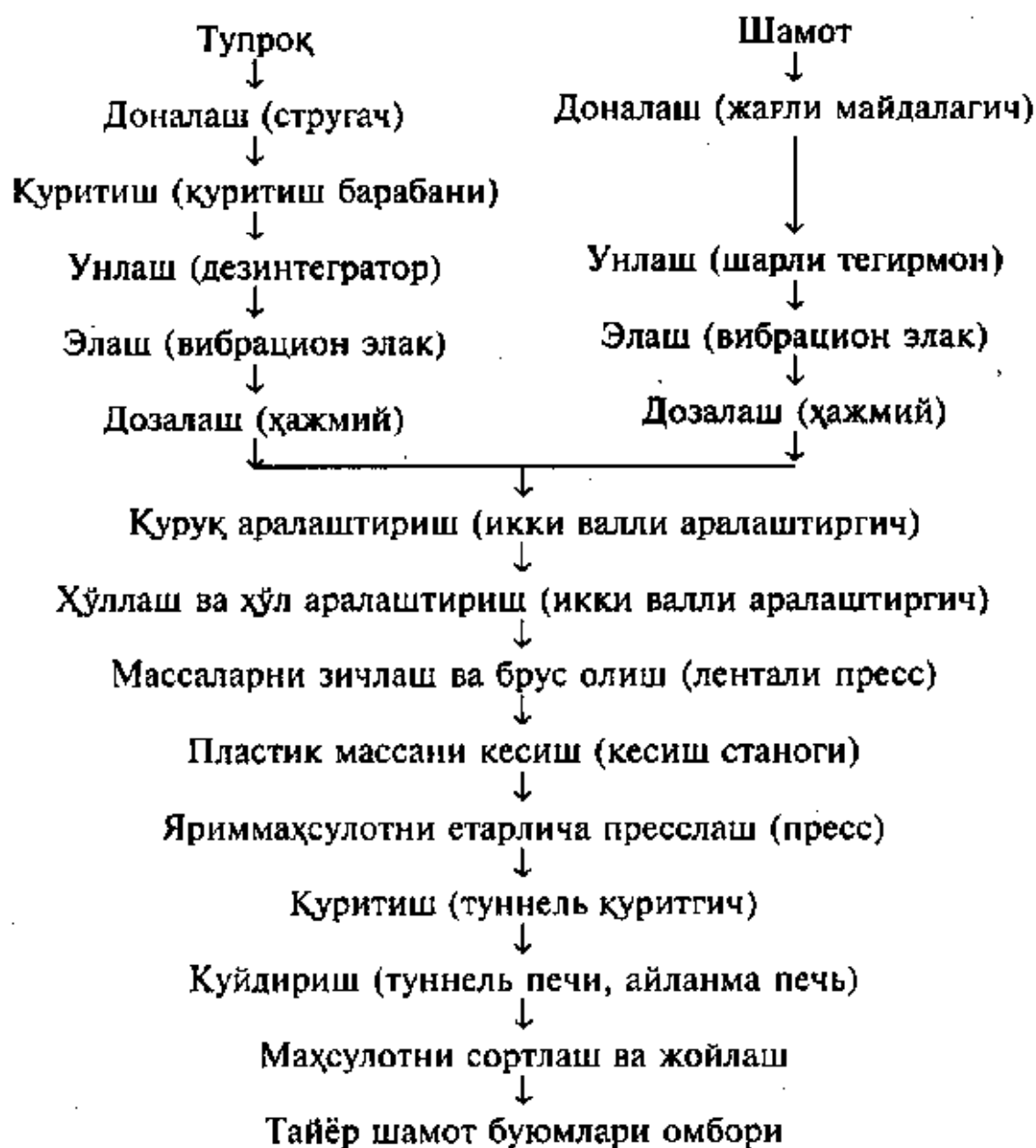
6- расм. Пластик пресслаш усулида шамот фишти олишнинг технологик схемаси.
