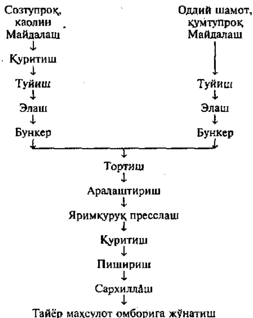
9-раем. Яримкуруқ усулда пресслаш орқали шамот буюмлари ишлаб чиқариш технологик схемаси.
