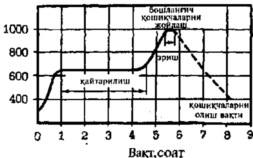
34- расм. GeO_2 ни қайтариш шароити ва ундаги германійли қошиқчанинг ўчоқда ҳаракатланиши.
