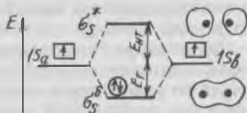
V.12-расм. Водород молекуласида молекуляр орбиталларнинг энергетик диаграммаси.
