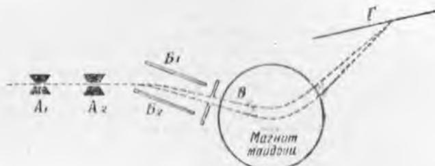
51-расм. Масс-спектрографининг схемаси.
