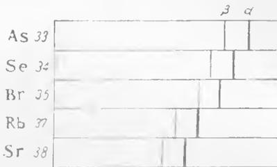
17-расм. Ядро зарядларнинг ортиб бориши тартибида жойлаштирилган элементларнинг рентген спектрларида  $K$  сериядаги чизиқларнинг бир-бирига нисбатан силжиши.
