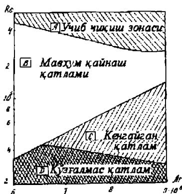
3.43-расм. Донатор - толали материалларнинг кўзгалмас, кенгайган ва мавҳум қайнаш қатлам ҳолатларининг мавжуд бўлиш чегаралари.
