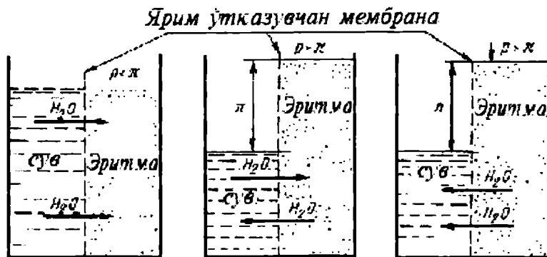
3.61-раем. Тескари осмос усулда эритмаларни ажратиш схемаси. а - осмос; б - мувозанат; в - тескари осмос.
