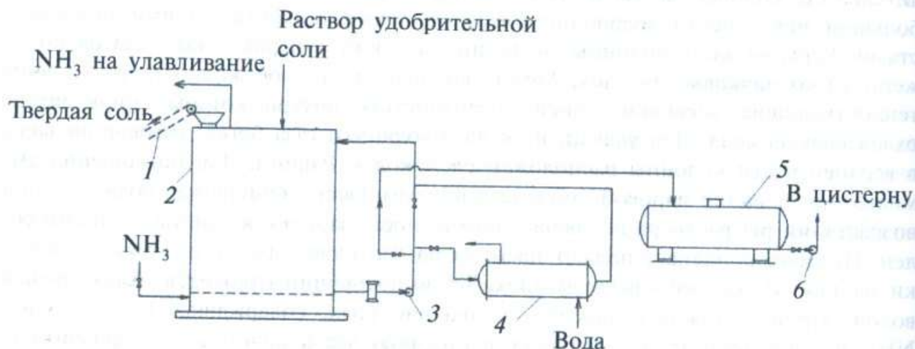
Рис. 59. Схема производства аммиакатов: 1 — транспортер; 2 — реактор; 3, 6 — насосы; 4 — холодильник; 5 — хранилище аммиакатов
