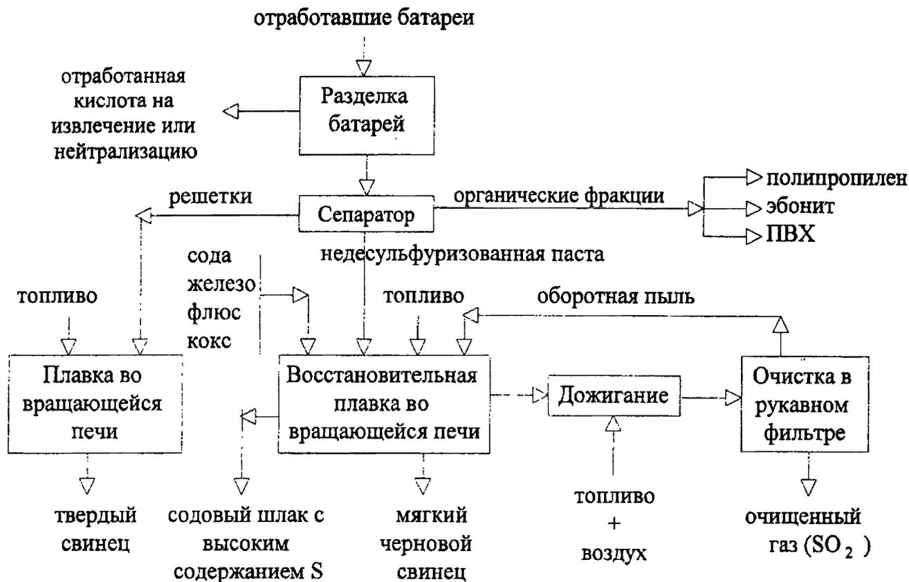
Рис 25. Технологическая схема отдельной плавки металлической фракции и недесульфуризованной пасты во вращающейся печи
