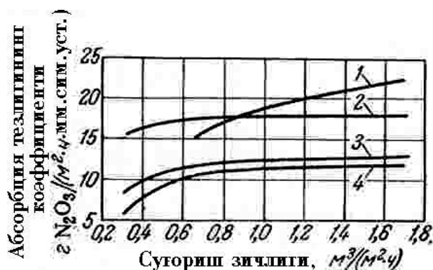
5.3-rasm. N_2O_3 absorbsiyasining turli to'ldirgichlardagi suyuqlikni taqsimlash zichligiga bog'liqligi:
