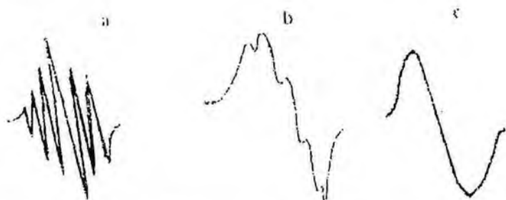
7.17-rasm. Saklüzta vodlorod yadrosi protonlaridan O'NS konstantalarining har xil kenglikdagi liniyalari: H=0,5 Gs – (a); H=5 Gs – (b); H=20 Gs – (c).
