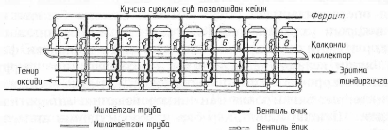
49-расм. Ишқорсизлантиргичлар батареясида суюқликнинг юриш схемаси.
