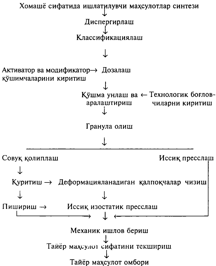
10- расм. Иш қуроли сифатида қўлланувчи керамик материалларни олиш технологик схемаси.
