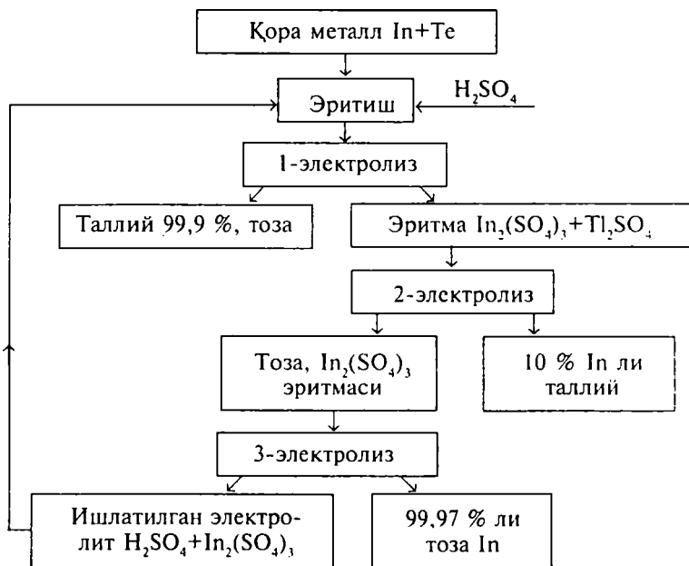
39-расм. Электрохимёвий усулда индий олишнинг технологик схемаси.
