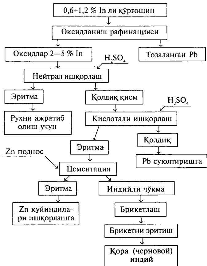
38-расм. Рух қорасини рафинациялашда ҳосил бўлган қўрғошин таркибидаги индийни ажратиб олиш технологияси.
