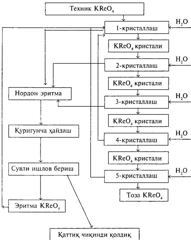
42-расм. Калий перренатни қайта кристаллаш орқали тозалашнинг технологик схемаси.
