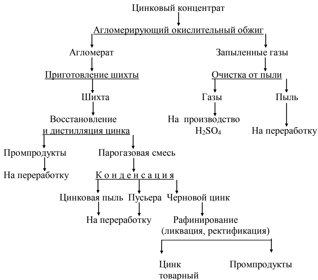
Рис. 1.2. Схема пирометаллургического способа переработки цинковых концентратов
