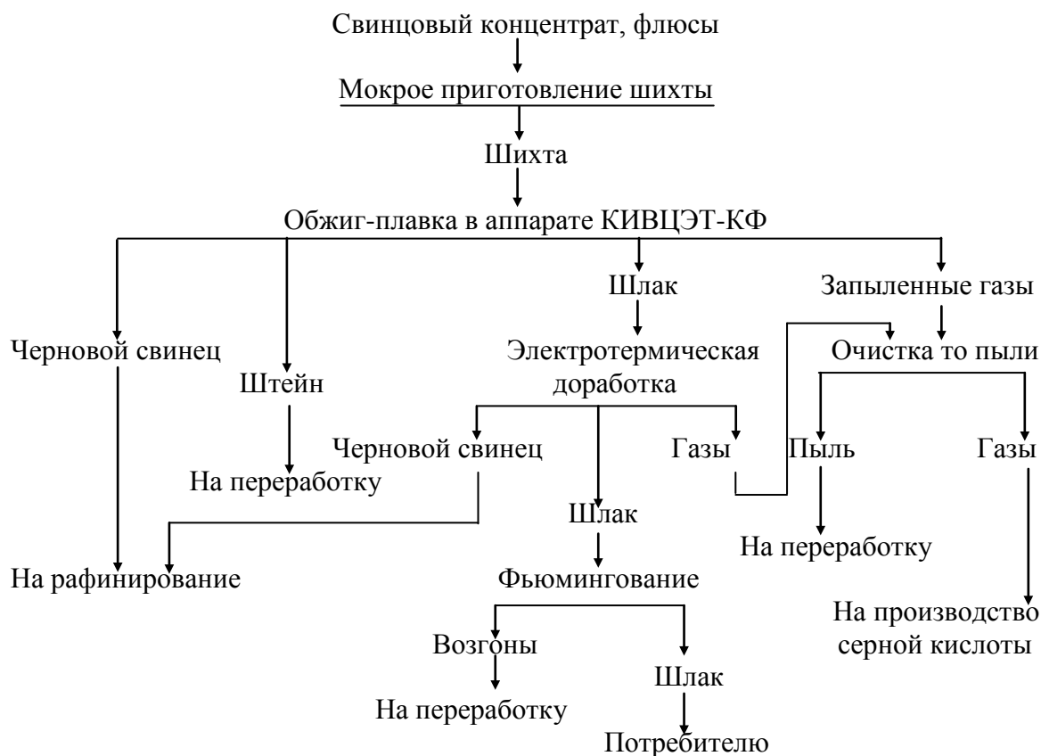
Рис. 2.16. Технологическая схема переработки свинцовых концентратов в аппарате КИВЦЭТ-КФ с доработкой шлаков методом фьюмингования
