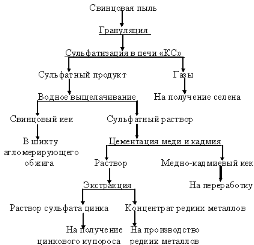
Рис. 2.9. Технологическая схема переработки свинцовых пылей с сульфатизацией крепкой серной кислотой
