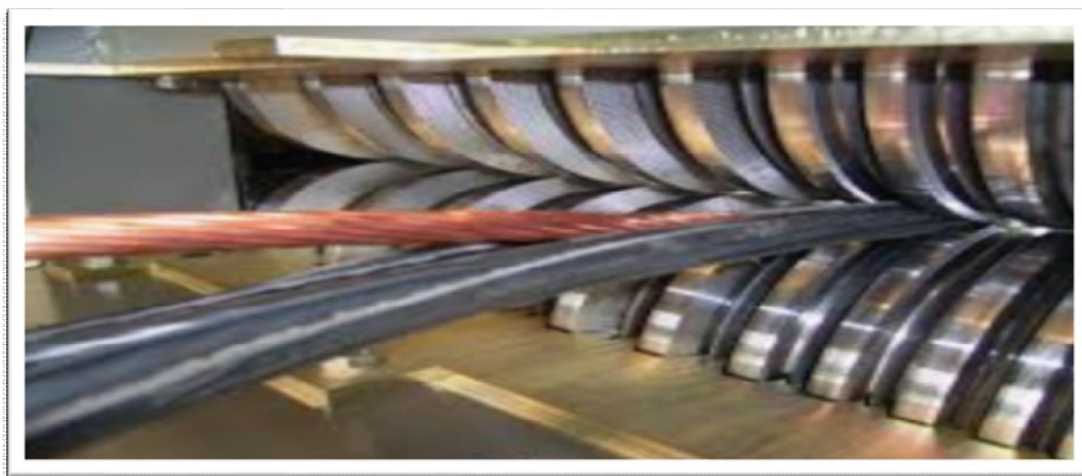
4.5-rasm. Kabelni izolyasiyadan tozalovchi pichoq
