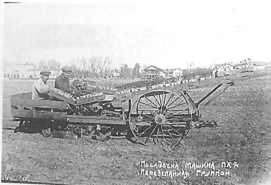
Кучат экадиган машина иш жараёнида
