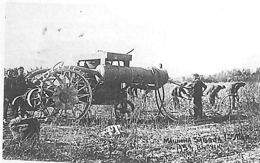
МАШИНА ЗАБОРА ЦЕЛЛЮЗНОГО ВЕЩЕСТВА 1959 г. ВЫПУСК Вакуумли пахта териш машинасида пахтани териш жараёни
