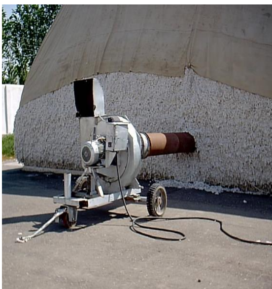
9-rasm. UVP rusumli ko'chma ventilyatorning g'aramga o'rnatilishi va qurilmaning tuzilishi.
