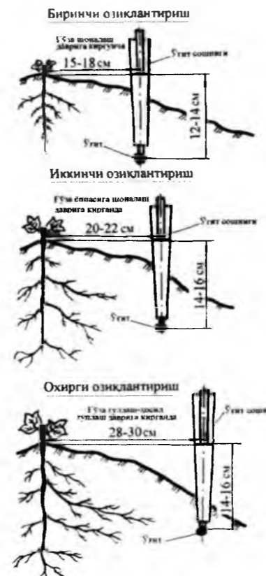
7.68-расм. 90 см ли қатор орасидаги ғузани озиклантиришда сошникларнинг ғуза тупига нисбатан жойлашиш схемалари
