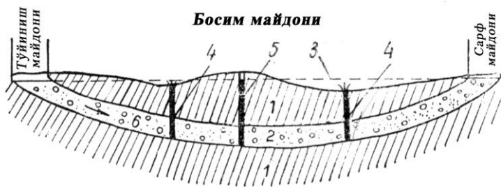
8- расм. Босимли er osti suvi хавзасининг тузилиш схемаси (Семихатов А.Н. бўйича): 1 - сув ўтказмайдиган қатламлар; 2 - сув ўтказувчи қатлам; 3 - кудуклардан сувни чиқиш баландлиги чизиғи; 4 - сув ўзи оқиб чиқувчи кудуклар; 5 - сув ўзи оқиб чиқмайдиган кудук; 6 - босимли er osti suвининг оқим йўналиши.
