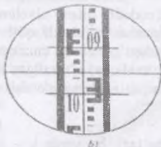
N-nivelirida Sanoq : 0989 dalnomer sanoqlari: 0935
