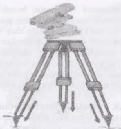
7.15-rasm. Nivelirni shtativga mahkamlash
