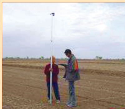
1.5.9-расм. Лазер узаткич трансмиттер ва ўлчов линейкасида ўрнатиш лазер қабул қилгич трансмиттердан узатиш маълумотни қўл лазер қабул қилгичдаги товушли сигналга қараб оператор даланинг ўлчов нуқтасини белгилаб олади.
