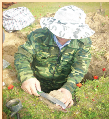
2.4.8-расм. Тупроқни ҳажм оғирлигини Качинский усулида аниқлаш жараёни.
