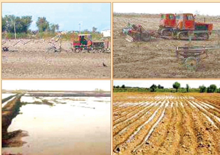
1.5.1-расм. Узун базали ва молаларда текислаш ва сўғориш сувини дала майдонида нотекис тақсимланишига олиб келувчи нотекисликлар.
