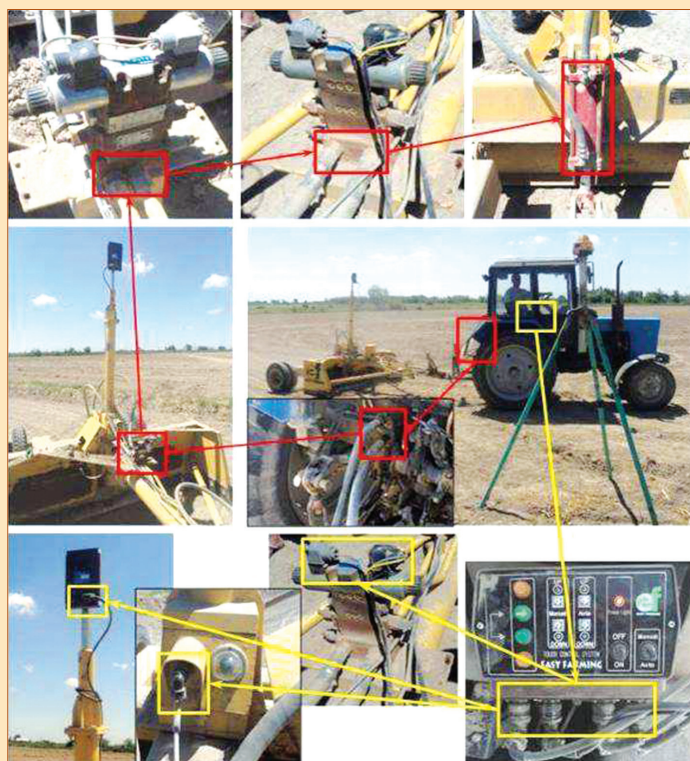
1.5.11-расм. Автоматик электр ва гидравлик уланиш тартиби. Қизил рангдаги гидравлик шланглар орқали ва сариқ электр симлар орқали уланиш. Маълумотларни бошқарув қурилмасининг уланиши расмда кўрсатилмаган.
