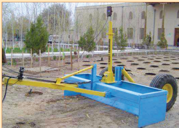
1.5.8-расм. Лазер текислагичнинг асосий қисмлари: 1 – тиркама рама; 2 – ковша; 3 – лазер нуруни қабул қилгич ресивер учун мачта; 4 – гидроцилиндр ва шланглар; 5 – ғилдирак ва ғилдиракли рама.
