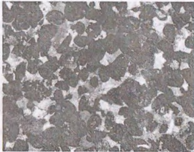
5.58-rasm. Oolit (qora) strukturali fosforit. Nikollar +
