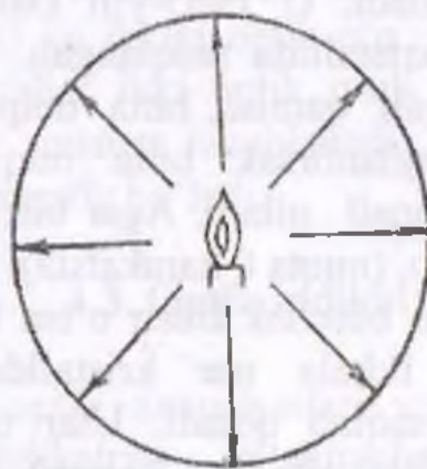
1.1 - rasm. Izotrop jism ichidagi yorug'lik manбайдan chiqayotgan nurlarning tarqalishi.
