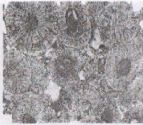
5.47-rasm. G'ovak teksturali yirik oolitli ohaktosh. G'ovakning ko'p qismi kalsit bilan to'ldirilgan. Eotsen, Turkiston yarusi. Shimoliy Farg'ona. Nikol. II; kattal. 40. A.I.Osipov koli.
