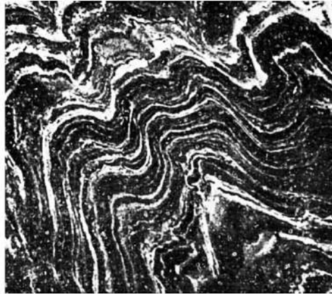
Рис. 19.3. Плойчатая текстура железных руд железистых кварцитов. Сложно смятые слои представлены кварцем (светлое) и магнетитом (серое и черное)
