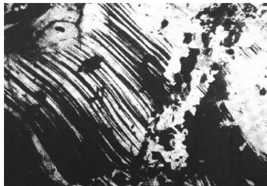
Рис. 5.7. Полисинтетические двойники давления в халькопирите. В центре – прожилок перекристаллизованного халькопирита. Месторождение Ахтала, Армения. Полированный шлиф
