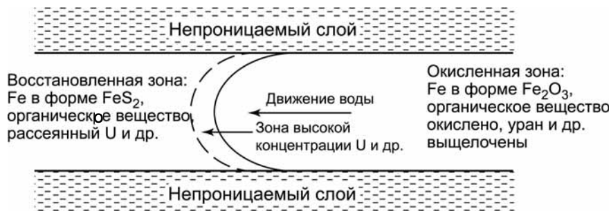
Рис. 4.7. Идеализированное сечение через инфильтрационное фронтальное месторождение урана в водоносном горизонте, сложенном песчаниками
