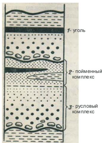
Рис. 113. Схема строения аллювиального цикла, по Г.Ф. Крашенинникову, 1971 [7]
