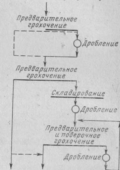
Рис. 14. Схема дробления руды при выделении мелочи в отдельный продукт и складирование грохоченой крупнодробленой руды
