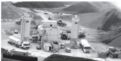
4.25-расм. Объектда ўрнатилган BHS TWIN MIX 3,00 СВМ маркали даврий тарзда ишлайдиган бетонқорғич қурилмалари.
