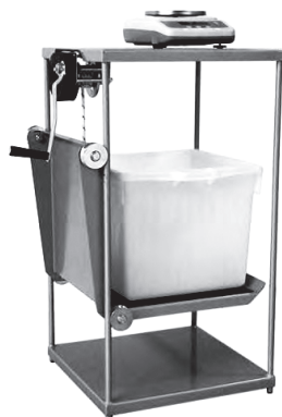
2.7-расм. Чақиқтош (шағал) ни гидростатик тортиш учун фойдаланиладиган техник тарозилар: 1 – тўрсимон (сертешик) стакан; 2 – сув тушадиган найчали идиш; 3 – шайин; 4 – питрали стакан; 5 – қадоқтошлар.
