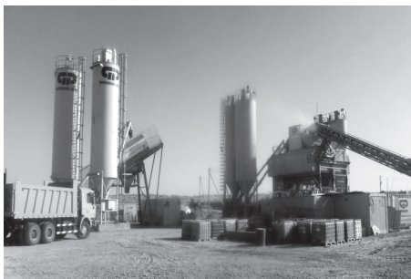
4.25-расм. Объектда ўрнатилган BHS TWIN MIX 3,00 СВМ маркали даврий тарзда ишлайдиган бетонқорғич қурилмалари.
