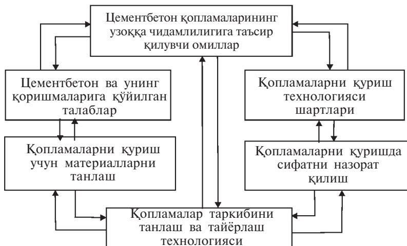
1.1-расм. Цементбетон қопламаларнинг узоққа чидамлигига таъсир қилувчи омилларнинг ўзаро боғлиқлиги (стрелкалар билан ўзаро таъсир кўрсатилган).
