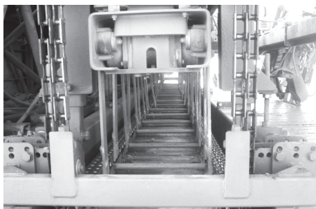
4.27-расм. Кўндаланг ва бўйлама чокларга штирлар ва арматураларнинг автомат равишда ўрнатилиши.
