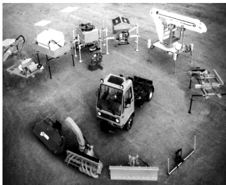
10.3-расм. Multicar базавий автомобили ва унга ўрнатиш мумкин бўлган ишчи агрегатлар.
