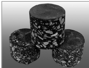
7.20-расм. Қопламадан кесиб олинган бузилмаган намуна.
