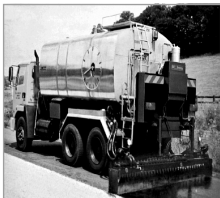
7.8-расм. Автогудранатор ёрдамида боғловчини сепиши.
