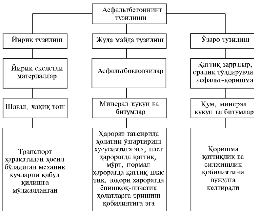
5.12-расм. Асфальтбетон тузилишининг ўзаро боғлиқлиги.
