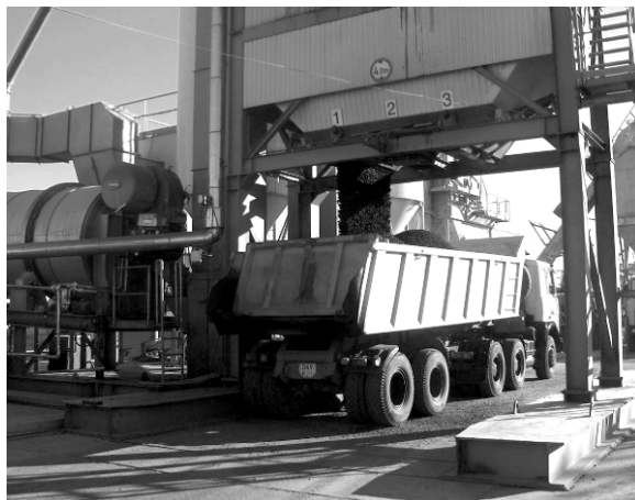
7.1-расм. АБЗ да автосамосвалга қоришмани юклаш жараёни.
