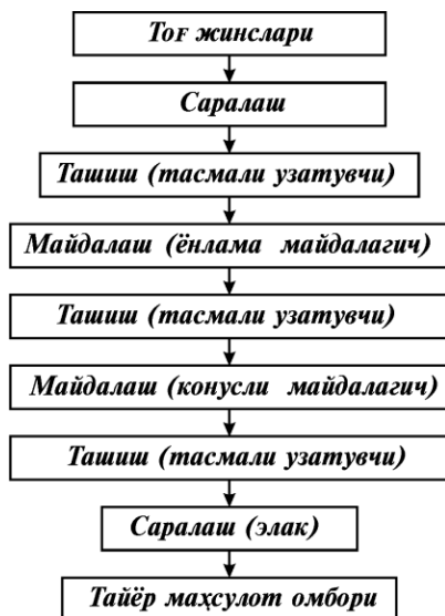
4.3-расм. Табиий тош материалларига узлуксиз ишлов бериш технологик жараёни схемаси.
