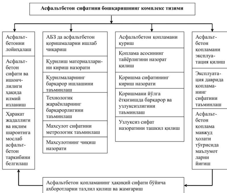
7.21-расм. Асфальтбетон қопламалар сифатини бошқариш схемаси
