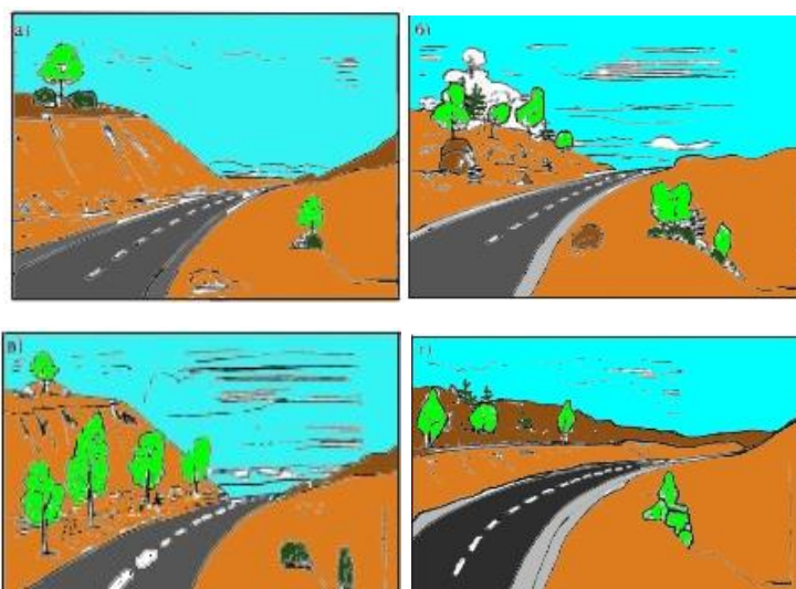
2.18-rasm. Baland koʻtarma va oʻymalarning yalangʻoch yon bagʻrini oʻsimliklar ekish bilan yashirish usullari: a – oʻymalarning koʻrksiz yalangʻoch yon bagʻri; b – yon bagʻrda daraxt va boʻtalarni ekish; v – yoʻl boʻyida baland daraxtlarni ekish; g – supacha qurish va yon bagʻrning supadan baland joylashgan qismida daraxtlar va boʻtalarni ekish bilan yon bagʻrning koʻrinish balandligini qisqartirish.
