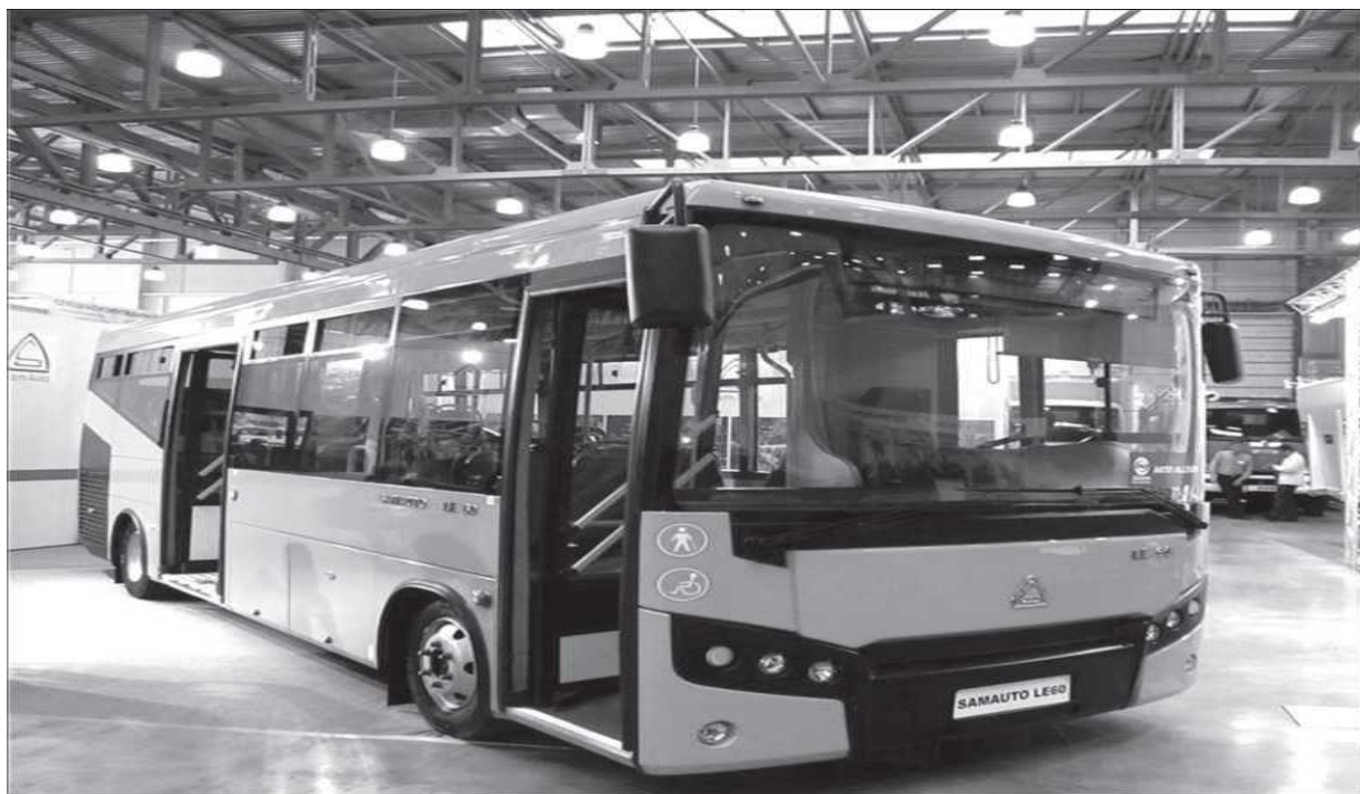
8.2-rasm. Shahar transportini nogironlarni o‘tirish va tushish uchun maxsus jihozlangan avtobus (SamAvto, O‘zbekiston)
