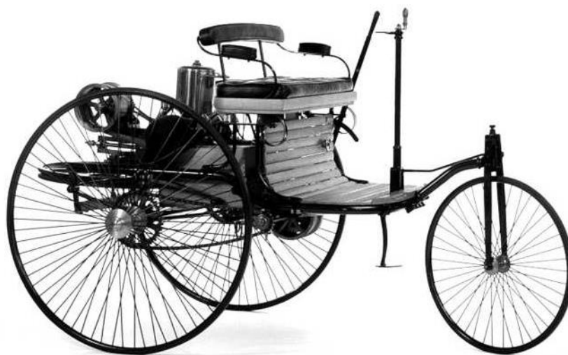
4.8-rasm. Bentsning Chikagodagi uch g'ildirakli avtomobili (1886 yil).
